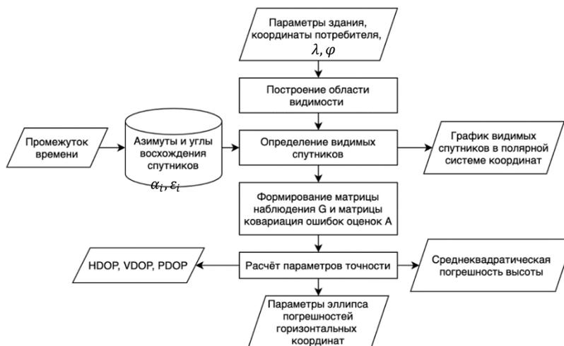
Рис. 1. Блок-схема программного обеспечения
