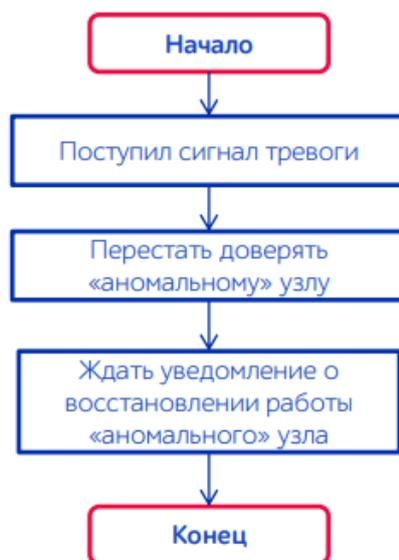
Рис. 3. Алгоритм действия узлов при получении сигнала тревоги от аномального узла
