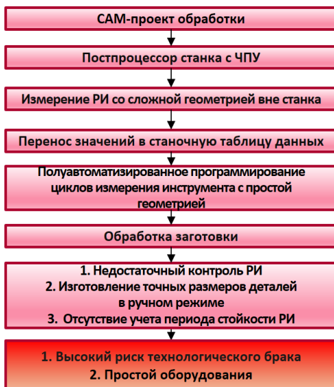
Рис. 1. Блок-схема последовательности изготовления детали при функционировании по стандартной производственной методике контроля РИ на станках с ЧПУ
