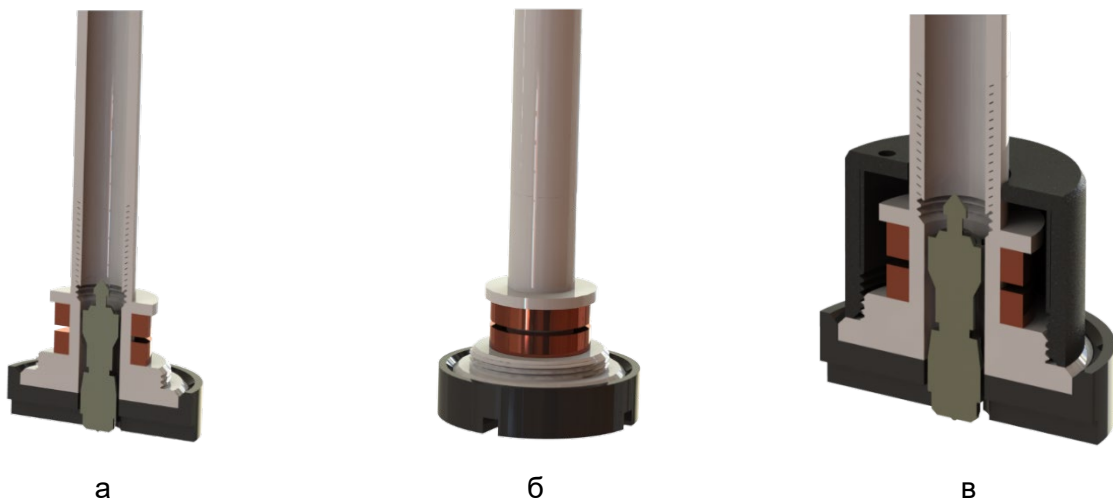
Рис. 4. 3D модель системы регистрации с двумя катушками и магнитом: а) без защитной крышки; б) без защитной крышки в разрезе; в) разрез системы регистрации с двумя катушками
