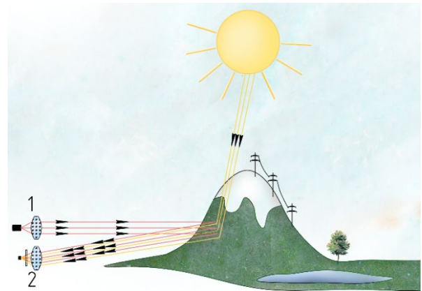
Рис. 2. Влияние шума фоновой засветки: 1 — передающая оптическая система; 2 — приемная оптическая система
