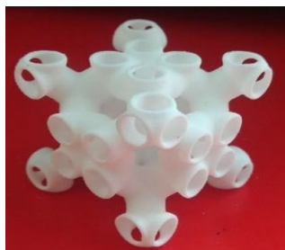
Рис. 3. Топологически оптимизированная конструкция куба для проведения испытаний на сжатие
