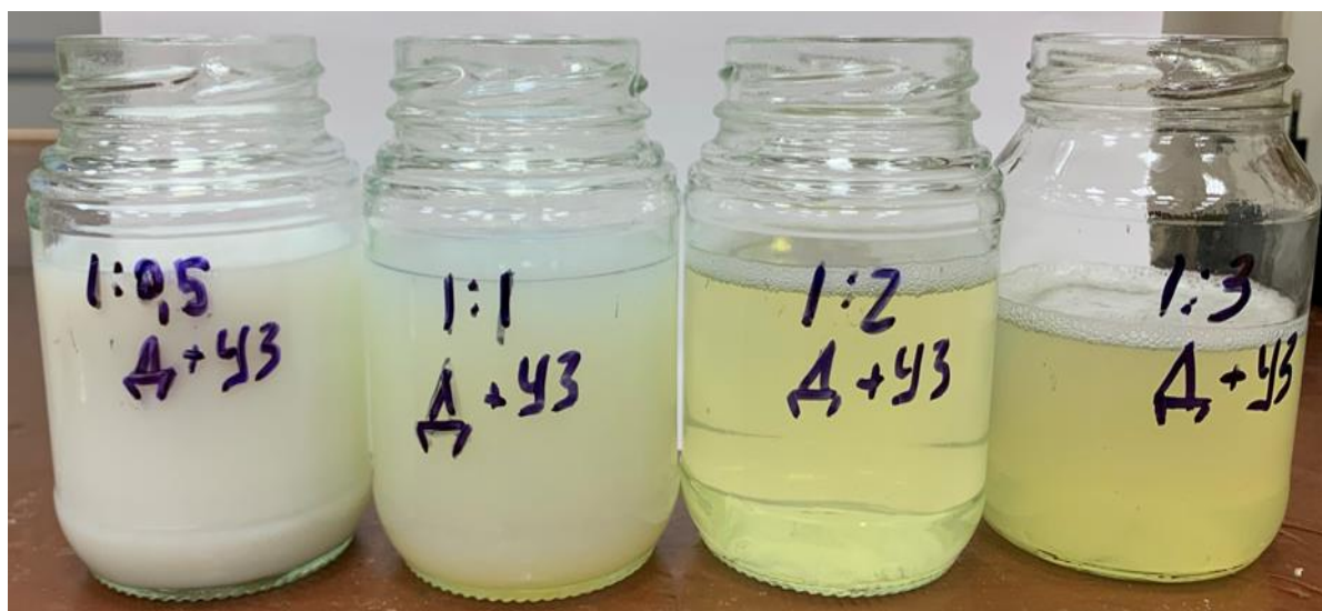
Рис. 3. Исследуемые образцы эмульсии с различной концентрацией эмульгатора после диспергирования и УЗ-обработки: слева направо — 5%, 10%, 20% и 30%
