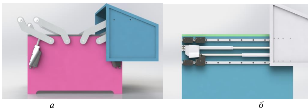
Рис. 5. Узел заслонок а) с рычажным механизмом; б) с рельсовым механизмом
