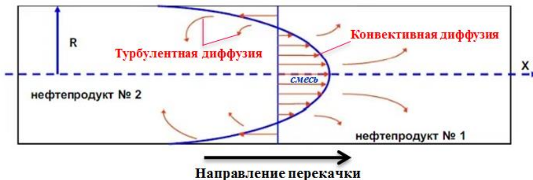
Рис. 1. Смесеобразование нефтепродуктов, перекачиваемых последовательно друг за другом
