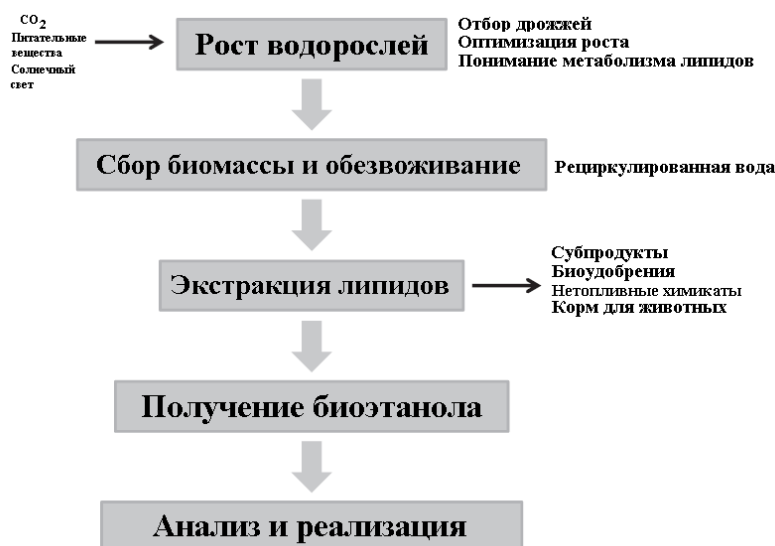
Рис. 1. Блок-схема, показывающая различные этапы производства биотоплива из водорослей
