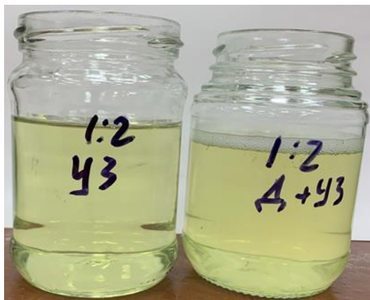
Рис. 4. Исследуемые образцы эмульсии с концентрацией эмульгатора 20%: слева – с перемешиванием и УЗ-обработкой, справа – с диспергированием и УЗ-обработкой
