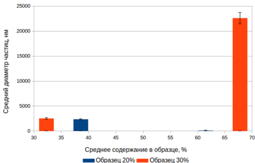
Рис. 6. Распределение частиц по размеру и количеству в образцах эмульсии с концентрацией эмульгатора 20% и 30%
