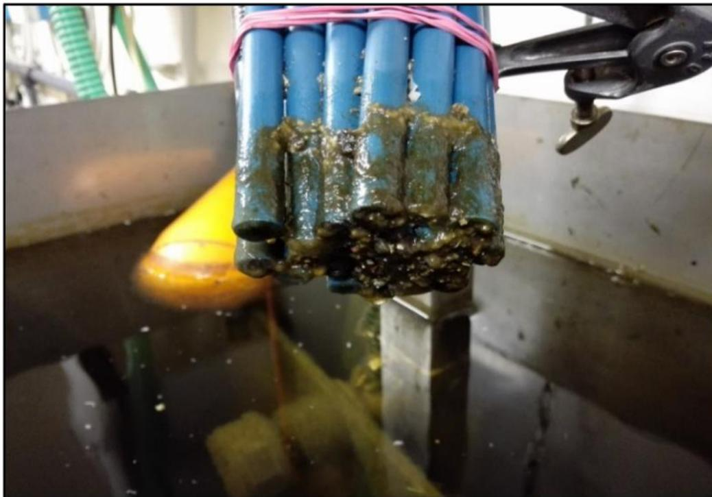
Рис. 2. Матрица датчиков после длительных онлайн-измерений на установке аэрации воды. Датчики очищались интенсивной промывкой. Несмотря на значительное загрязнение, датчики оставались стабильными не менее двух месяцев [4]
