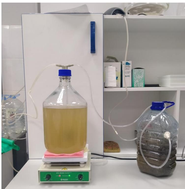
Рис. 2. Изображение лабораторной установки биологической фильтрации воздуха
