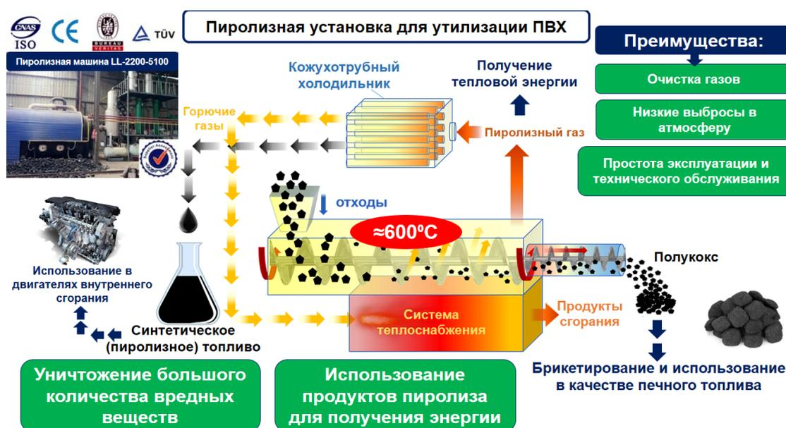
Рис. 4. Технологический процесс
