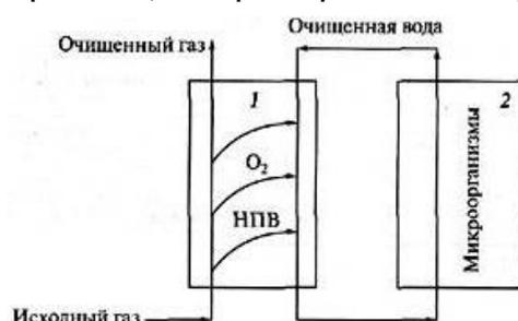
Рис. 1. Биофильтрация - многоступенчатая схема процесса: 1 – очистка отходящего воздуха (абсорбция); 2 – микробиологическая очистка загрязненной воды (регенерация воды)
