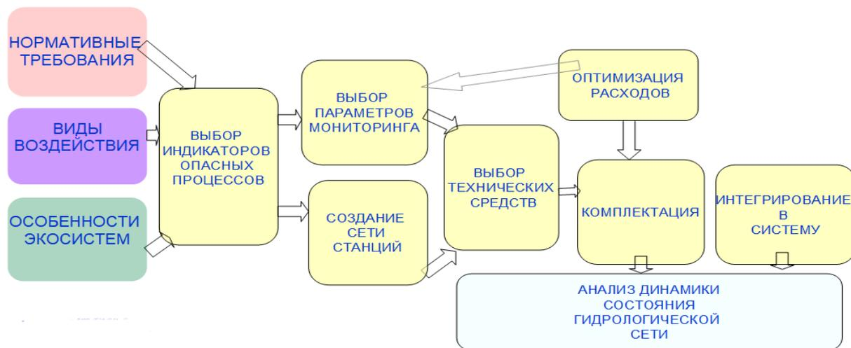
Рисунок. Алгоритм создания системы автоматизированного мониторинга качества воды с применением сенсорных датчиков малых таежных рек в районах лесопользования
