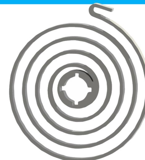
Рассчитанная и сгенерированная пружина для модуля типа Б
