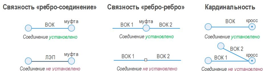
Рис. 4. Связность сетевых элементов в Geometric Network
