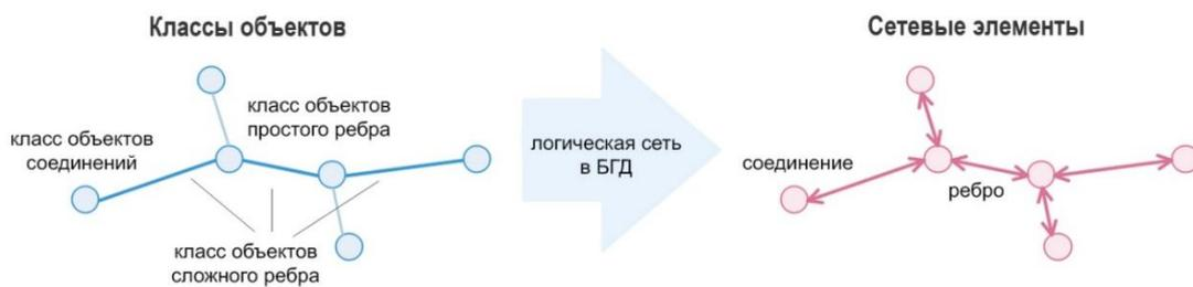
Рис. 3. Классы объектов и сетевые элементы модели Geometric Network
