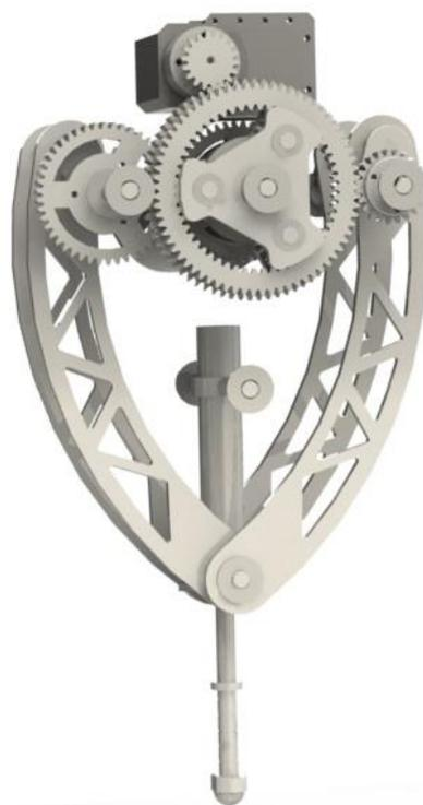
Рис. 1. Модифицированная конструкция ноги
