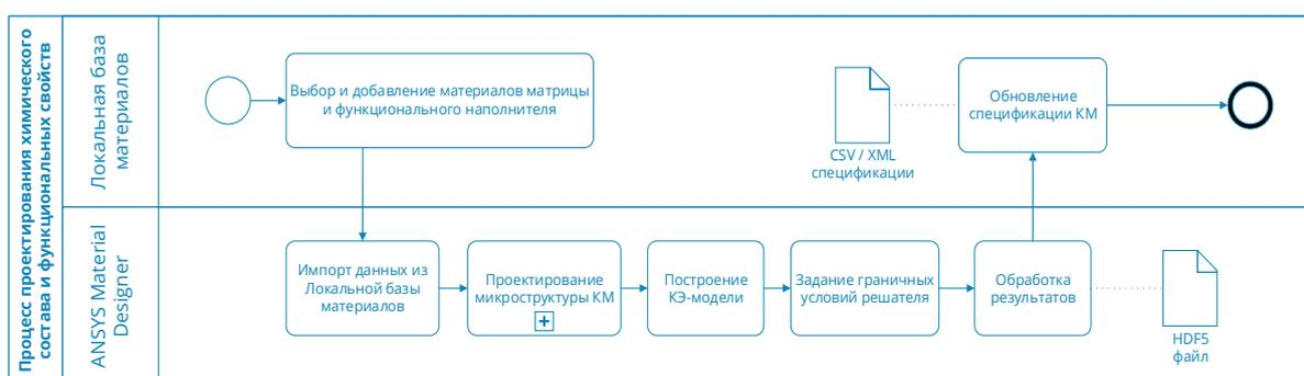
Рис. 4. Информационная модель обмена данными между локальным хранилищем ANSYS Workbench и расчетным процессором ANSYS Material Designer
