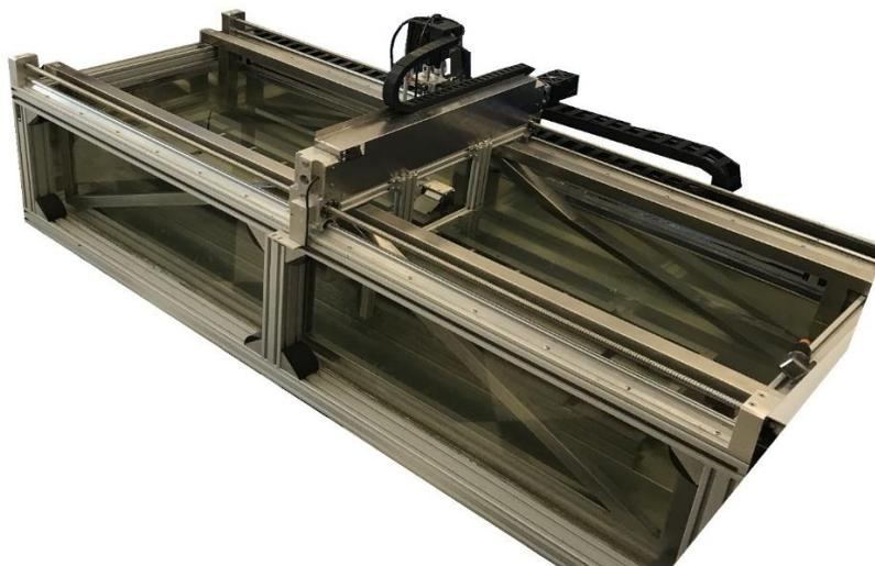
Рис. 1. Внешний вид комплекта позиционирования и перемещения преобразователей
