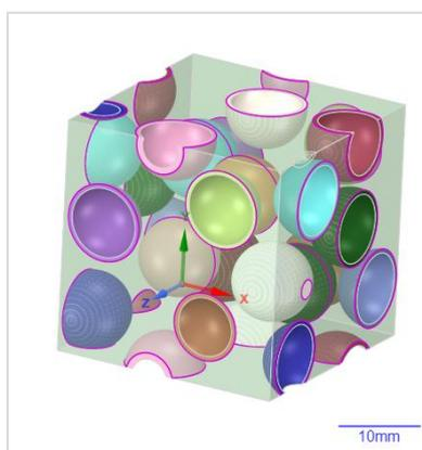
Рис. 5. Конструкция представительного объема исследуемого композиционного материала: сплошная матрица и полый наполнитель
