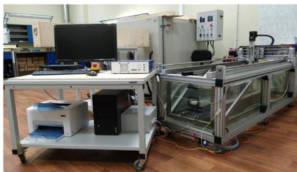
Рис. 4. Автоматизированный комплекс для неразрушающего контроля ПБГА
