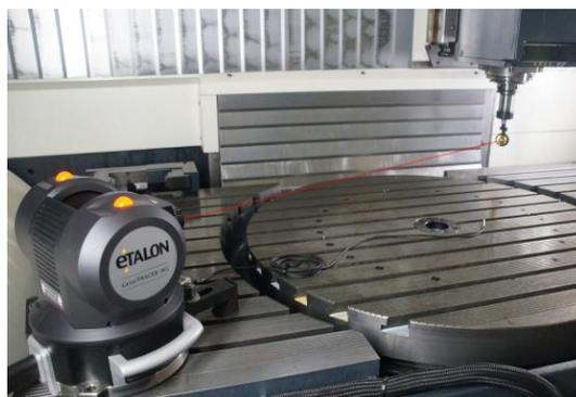
Рис. 5. система Etalon Laser TRACER-NG
