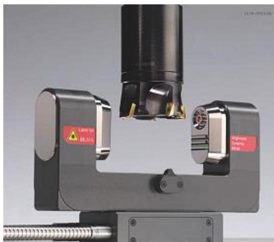
Рис. 7. Лазерная измерительная система LC50-DIGILOG
