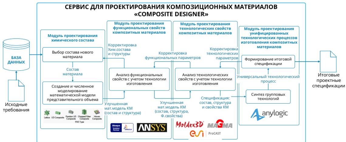
Рис. 1. Архитектура сервиса для проектирования композиционных материалов «Composite Designer» в индустриальной киберфизической платформе
