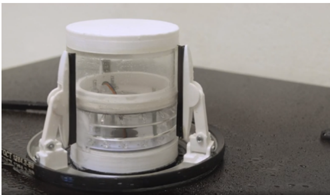
Разработка системы автоматической очистки лидара беспилотного автомобиля руководитель Станислав Рочас, аспирант ФЛФО
