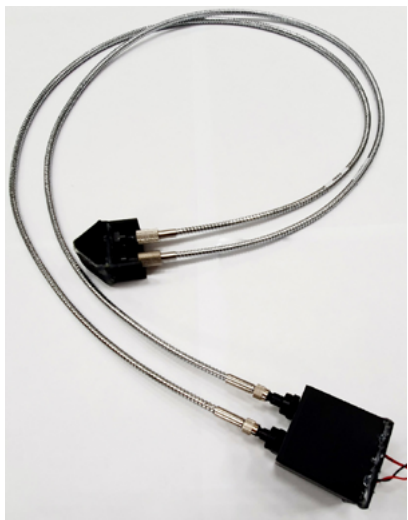
Разработка оптического датчика тока с чувствительным тонкопленочным элементом на основе ферромагнитного материала
