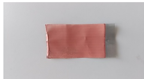
Наночастица оксида меди, осаждённая на стальную сеточку
