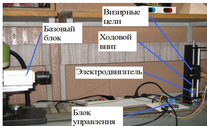
Рис. 3. Макет канала системы адаптации главного зеркала РТ миллиметрового диапазона
