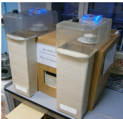
Рис. 1. Экспериментальная установка по определению эффективности ионизированной и озонированной среды
