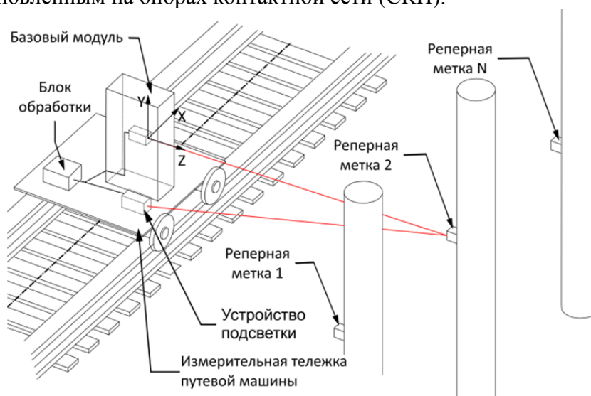
Рис. 1. Схема построения измерительной цепи оптико-электронной системы контроля положения железнодорожного пути
