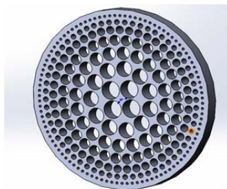
Рис. 2. Модель образца для исследования точности печати принтера с размером сопла 0,3 мм
