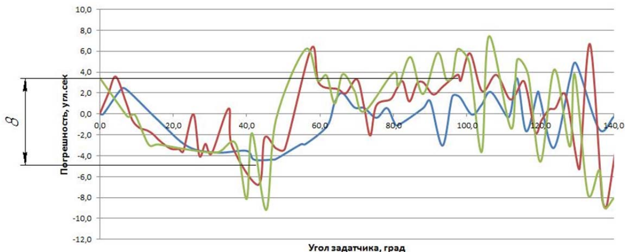
Рис. 3. Зависимость погрешности от угла на гониометре
