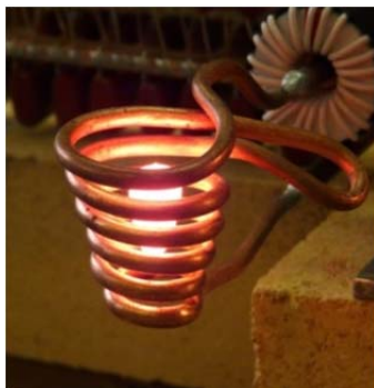
Рис. 2. Высокочастотный индуктор с обратным витком
