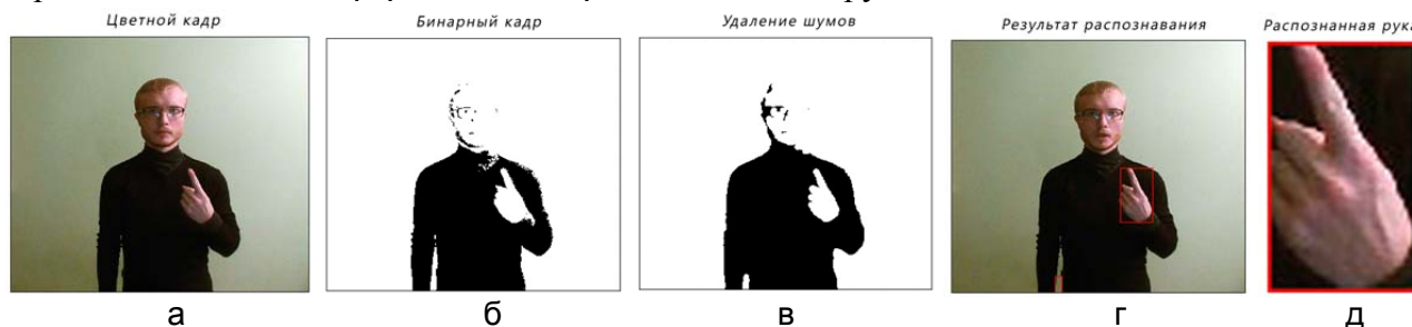
Рис. 3. Иллюстрация выполнения алгоритма выделения рук: цветной кадр (а); бинарный кадр (б); удаление шумов (в); результат распознавания (г); распознанная рука (д)
