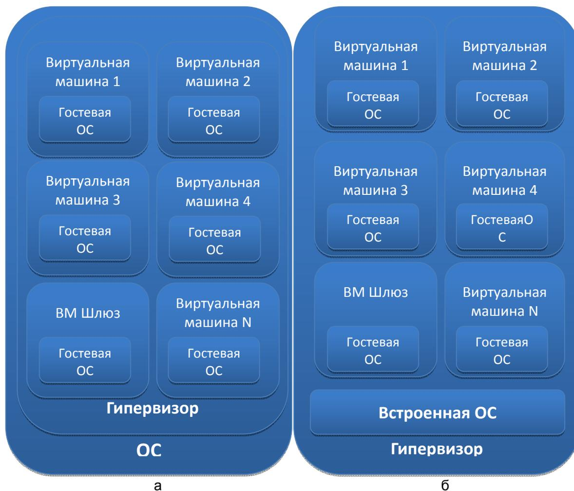
Рисунок. Схема гипервизора: когда гипервизор содержит в себе компоненты операционной системы (ОС), т.е. является автономным (а); когда гипервизор функционирует на предустановленной (базовой) ОС (б)
