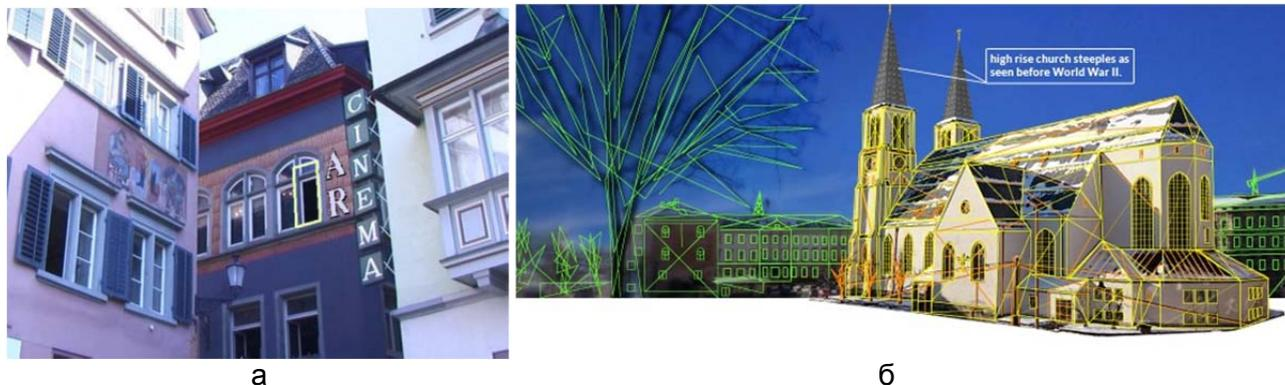
Рис. 1. Наложение виртуальных объектов на реально существующие (а); распознавание геометрии здания с помощью SLAM (б)
