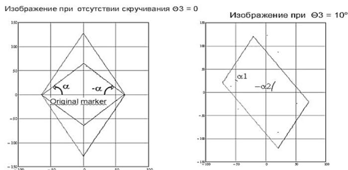
Рис. 1. Вид в плоскости приемного матричного поля опико-электронной системы
