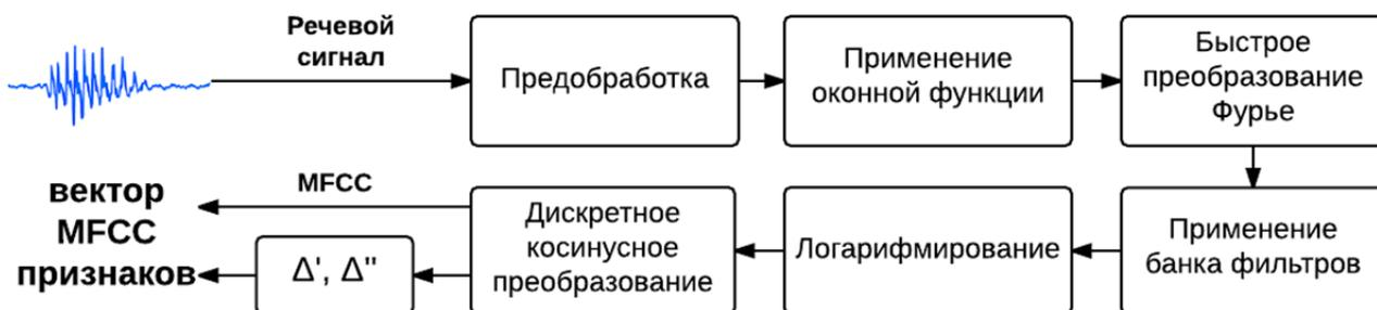
Рис. 1. Модуль извлечения MFCC-признаков
