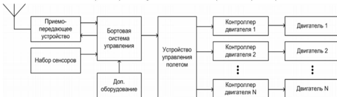
Рис. 1. Общая схема устройства мультикоптера
