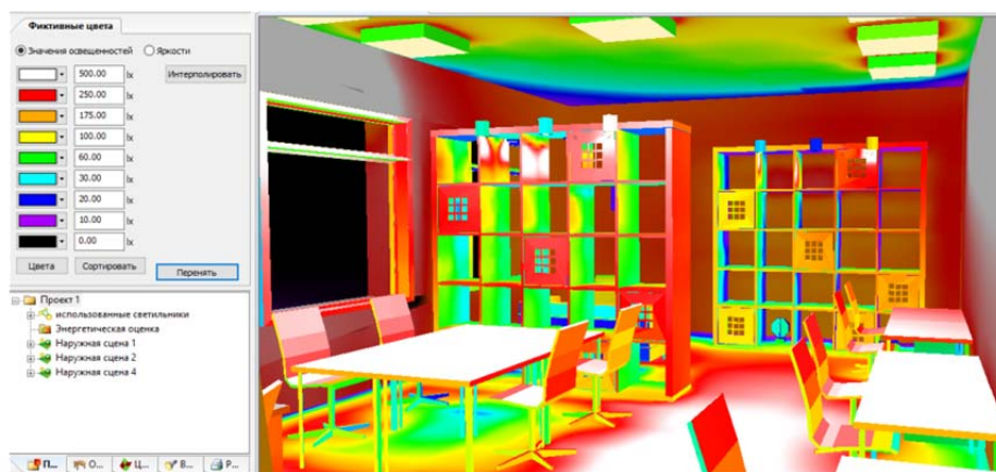
Рис. 1. Отображение фиксированных цветов в DIALux
