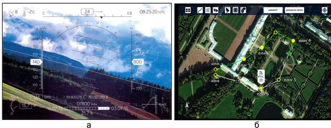
Рис. 1. Вид экранов графического интерфейса: полетного экрана (а); экрана полетного задания (б)
