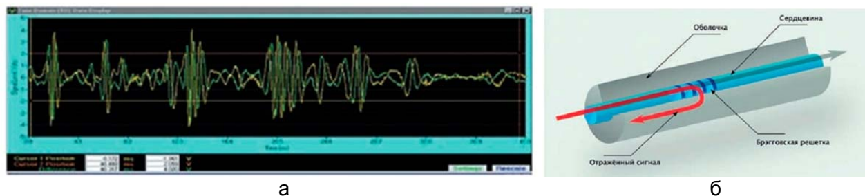
Рис. 3. Осциллограмма сигналов системы с локализацией вторжения (а); принцип когерентной оптической рефлектометрии с временным разрешением: регистрация лазерного излучения, отраженного от неоднородностей оптического волокна (б)
