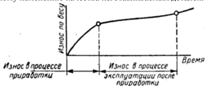
Рис. 1. Зависимость износа по весу от времени
