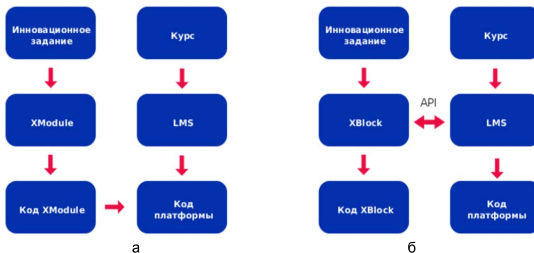
Рис. 2. Взаимодействие XModule (а) и XBlock (б) с системой
