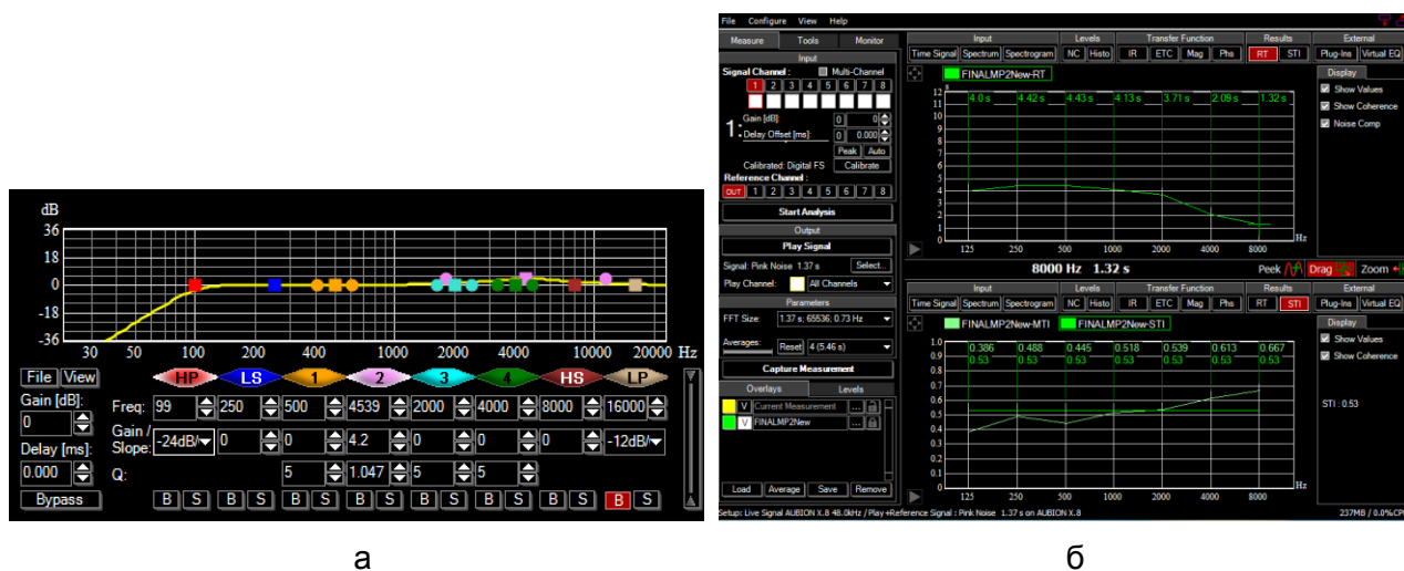
Рис. 2. Встроенный эквалайзер в программе SysTune (а); время реверберации и индекс передачи речи в программе SysTune (б)
