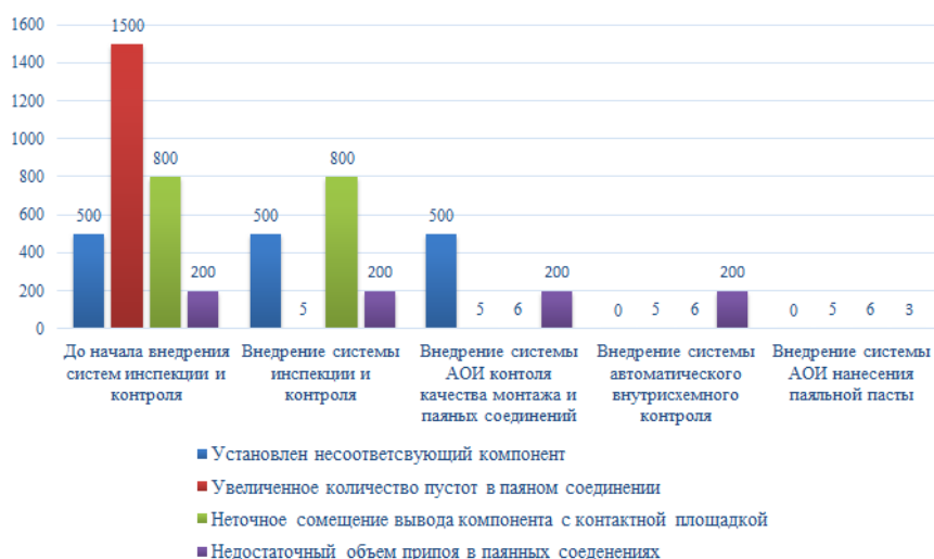
Рис. 2. Диаграмма обнаружения технологических дефектов после последовательного внедрения автоматических систем инспекции и контроля [4]
