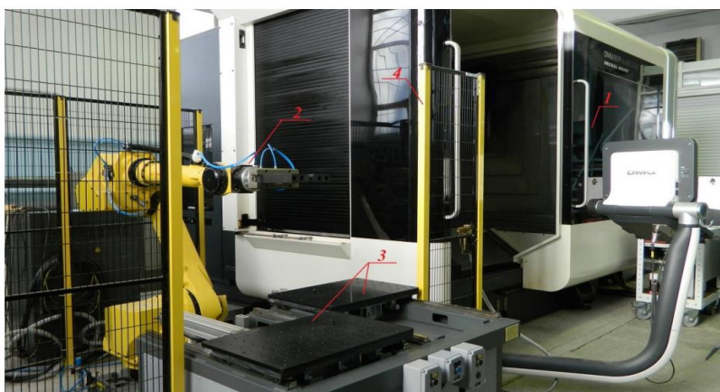
Рис. 1. Фрезерный робототехнический комплекс: 1 – фрезерный обрабатывающий центр DMU 80P; 2 – промышленный робот Fanuc M-710 iC/50; 3 – тактовые столы; 4 – защитное ограждение
