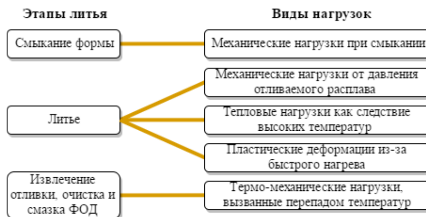
Рис. 1. Нагрузки на формообразующую деталь на разных этапах литья
