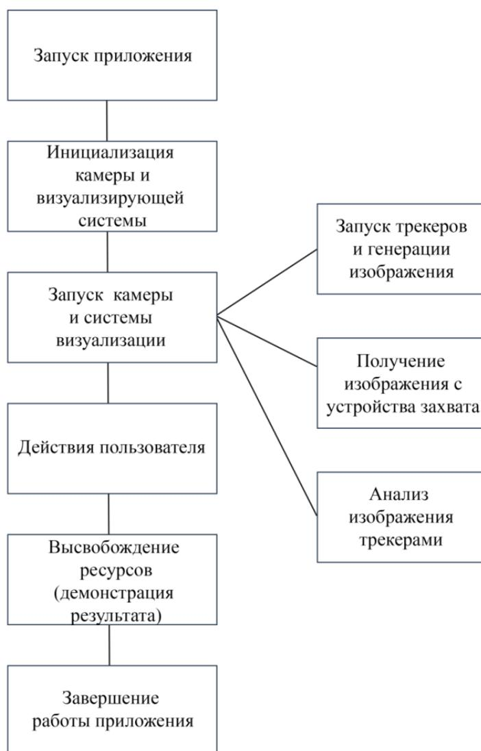
Рисунок. Процесс работы дополненной реальности
