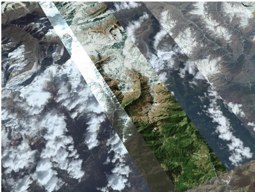
Рис. 2. Проблемы спутниковых датасетов: облака и тени, а также стыки между спутниковыми фотографиями разных источников в датасете Bing Maps
