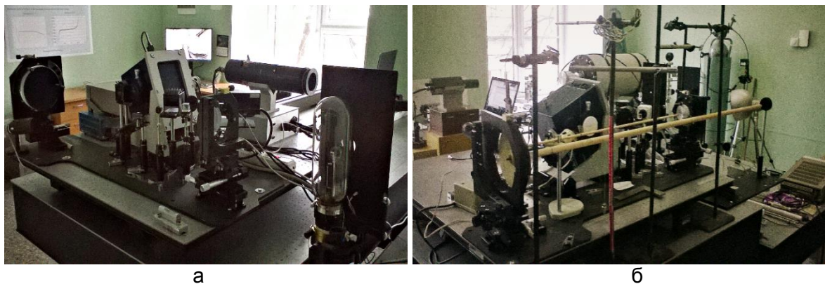
Рис. 2. Компоновка основных узлов компаратора спектральных яркостей на платформе (а); внешний вид макета установки эталона единицы температуры в процессе юстировки (б)
