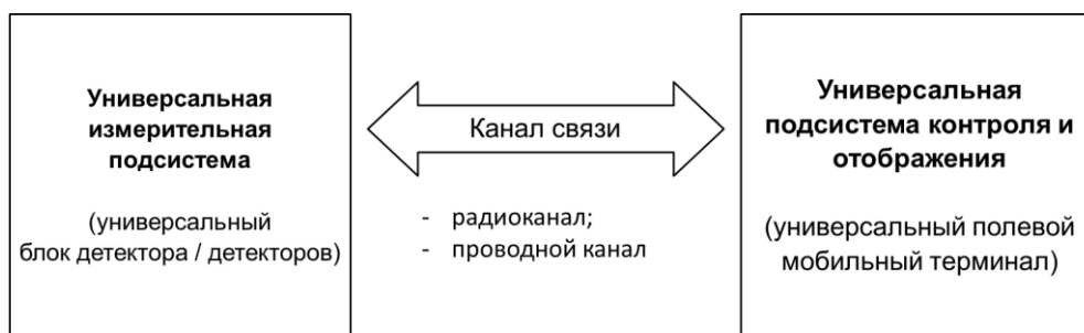
Рис. 2. Универсальная архитектура полевого геофизического прибора
