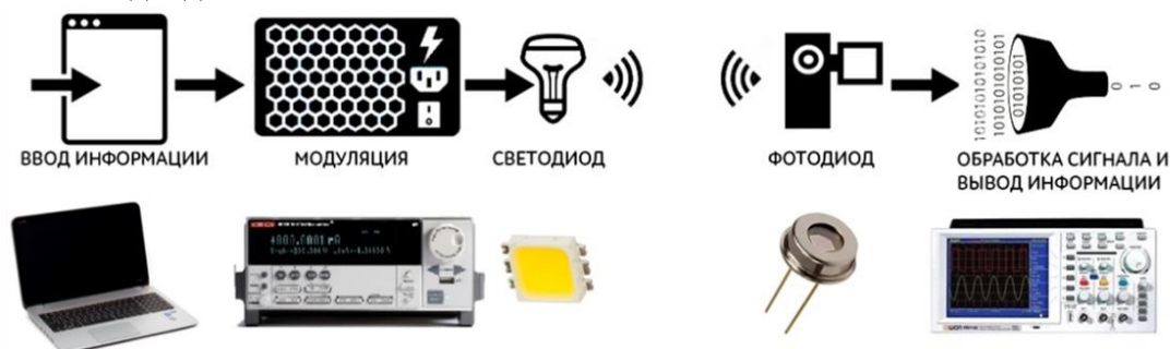
Рис. 2. Общая модель экспериментального стенда
