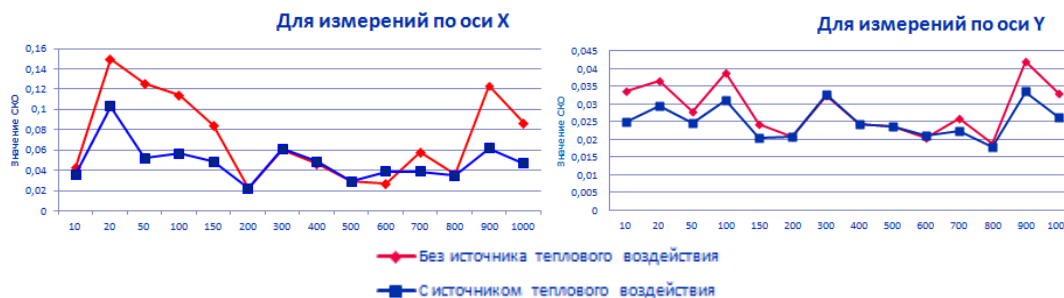
Рис. 2. Графики зависимости значений СКО от частоты кадров для красного канала светодиода
