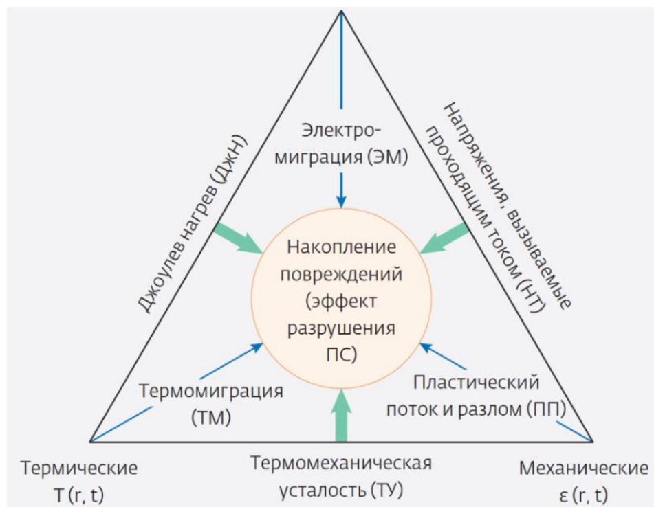
Рис. 1. Факторы, приводящие к повреждениям ПС
