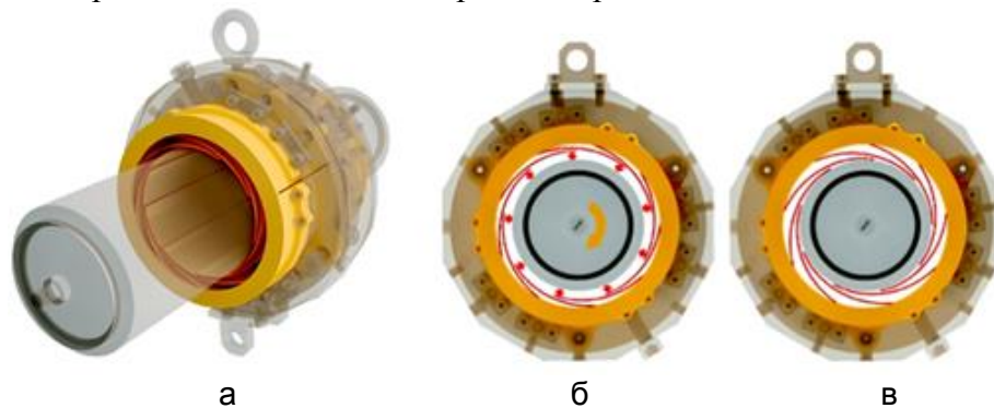
Рис. 2. Типичная конструкция лепесткового газодинамического подшипника: общий вид (а); подшипник в рабочем состоянии (б); подшипник при неподвижном валу (в)
