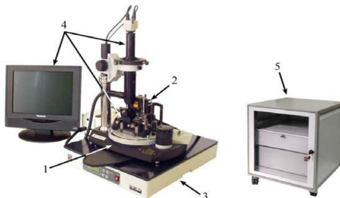
Рис. 2. Зондовый микроскоп Ntegra Aura: 1 – базовый блок, 2 – измерительная головка, 3 – система виброизоляции, 4 – система видеонаблюдения, 5 – система управления
