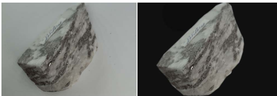
Рис. 1. Выделение контуров с помощью межкадровой разности в совокупности с оператором Кени
