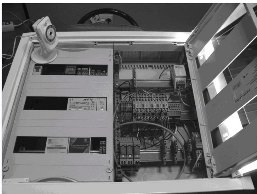
Рис. 5. Внешний вид разработанного лабораторного стенда «умный дом»
