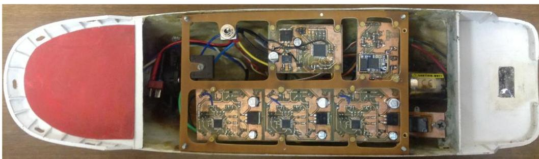
Рис. 1. Электронные компоненты модели судна
