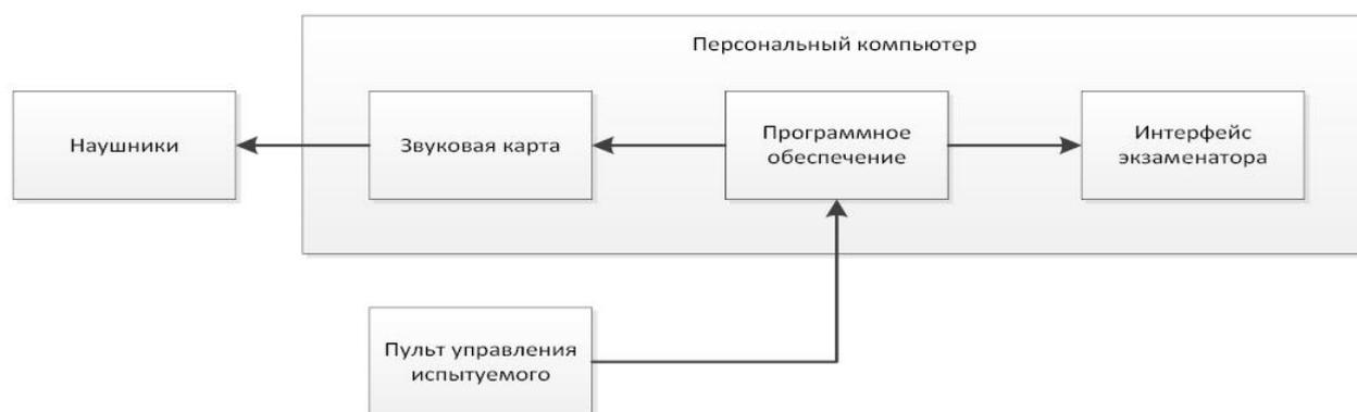
*Рис. 1. Схема программно-аппаратного комплекса*
