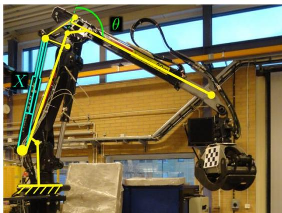
*Рис. 3. Управляемое звено исследуемого крана-манипулятора:  $X$  – линейная координата, описывающая степень выдвижения звена;  $\theta$  – угловая координата звена, связанная геометрически с линейной*
