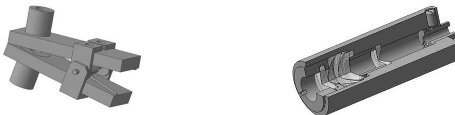
Рис. 3. Элементы макета: а – клипса, б – оптическая система
