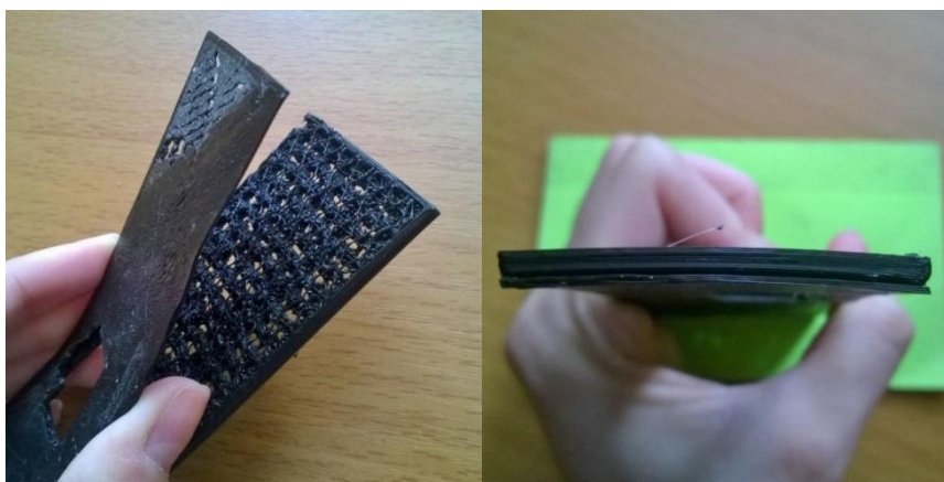
Рис. 1. Ограничения FDM-печати: а – деламинация первых слоев основания модели; б – скругление прямых углов
