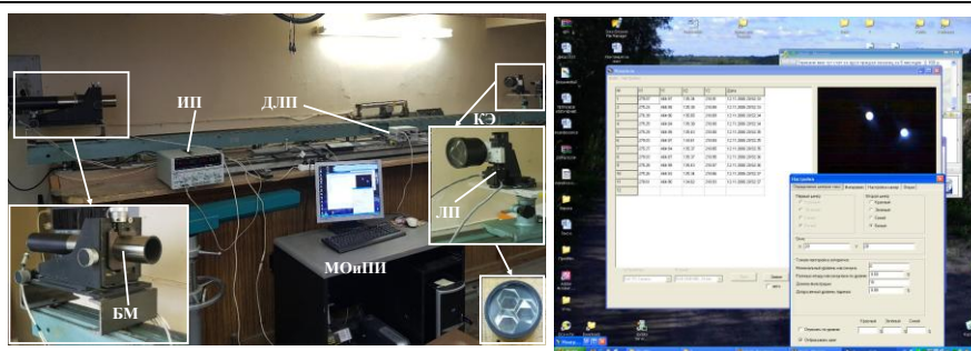
Рис. 7. Общий вид размещения модулей опытного образца «ОЭСКС-2» на стенде испытания линейных пространственных координат (использовался дуплексный отражатель)
