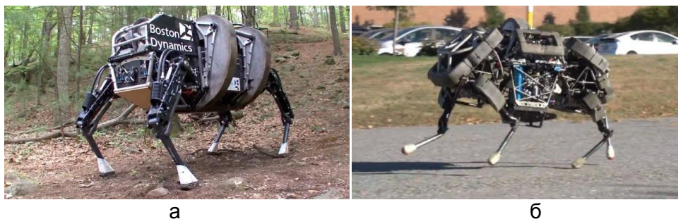
Рис. 1. Робот «LS3» (а), являющийся улучшенной версией шагающего робота «Big Dog», разработанного компанией Boston Dynamics; робот «Wild Cat» (б), являющийся улучшенной версией робота «Cheetah», разработанного компанией Boston Dynamics совместно с MIT's Biomimetic Robotics Lab
