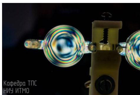
Рис. 3. Изохроматические полосы распределения внутренних напряжений и полосы изоклин
