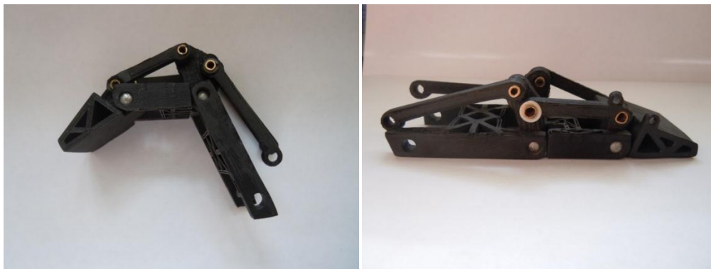
Рис. 4. Палец зажимного узла в собранном виде, детали из АБС пластика
