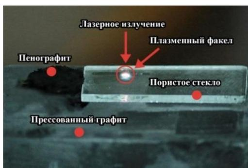
Рис. 2. Процесс микроструктурирования стекла
