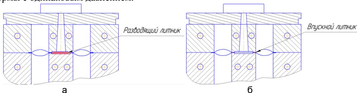
Рис. 1. Литник: разводящий (а); впускной (б)
