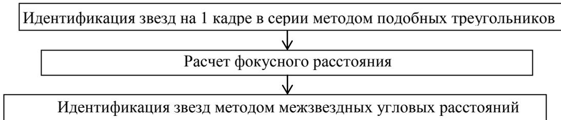
Рис. 2. Блок-схема комбинированного алгоритма идентификации звезд
