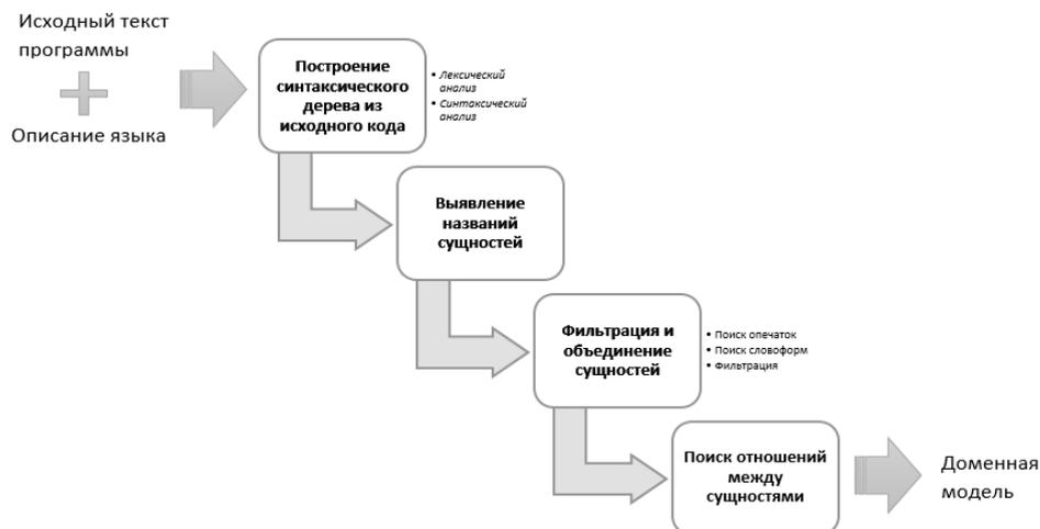
Рисунок. Общая схема работы алгоритма
