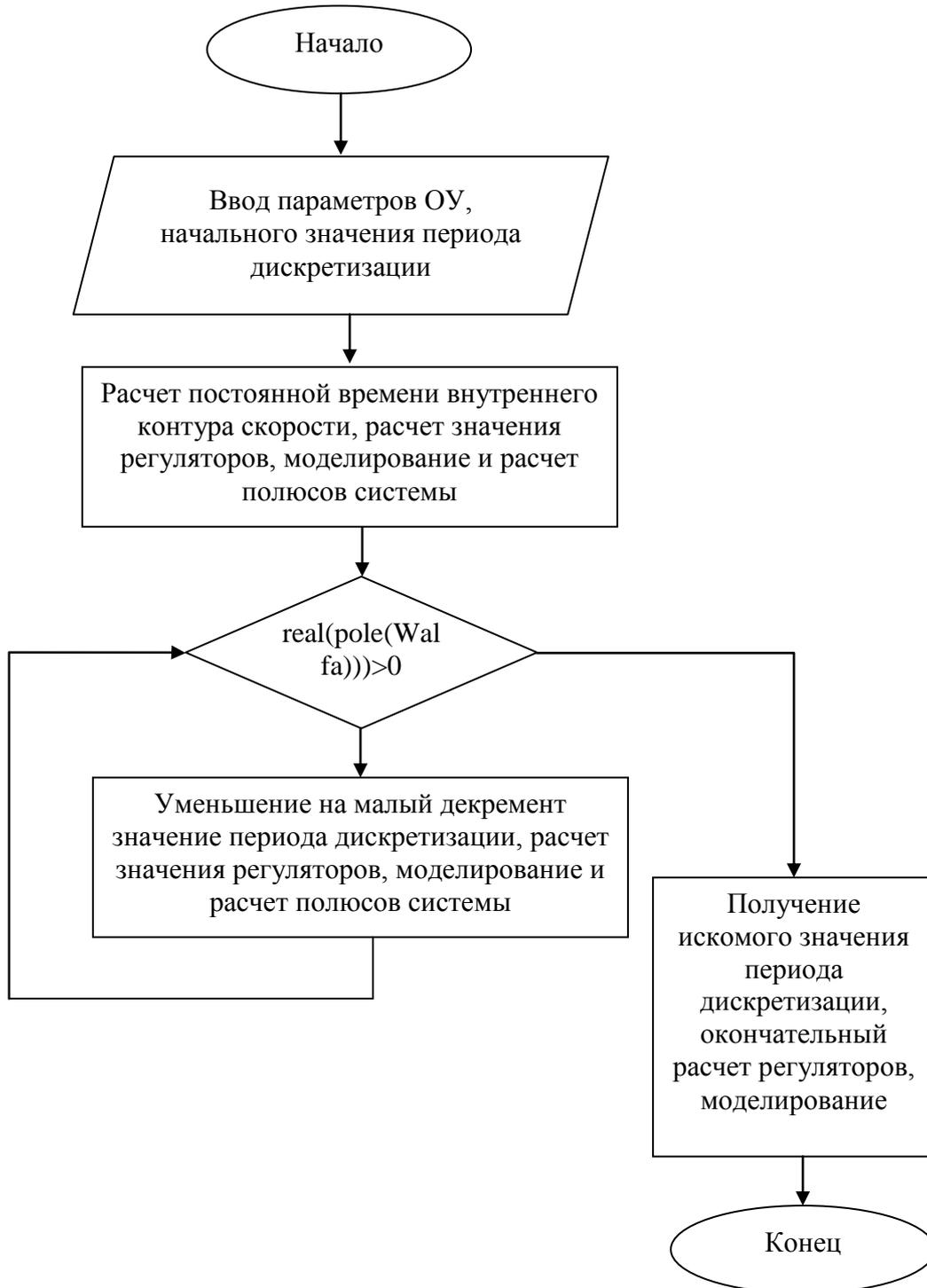
Рис. 4. Цикл вычисления оптимального периода дискретизации
