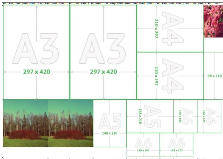
Рис. 1. Пример макета для изготовления печатной формы
