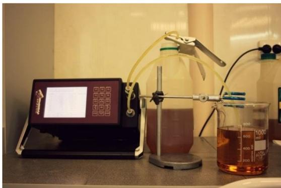
Рис. 2. Контроль параметров счетчиком Pamas модели S-40
