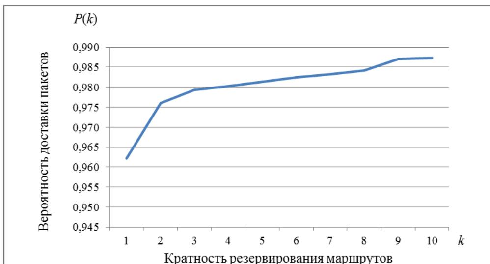
Рис. 3. График зависимости вероятности доставки пакетов от кратности резервирования маршрутов
