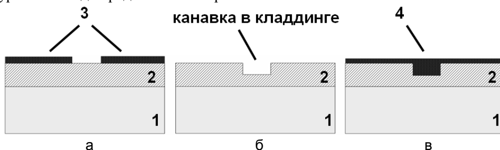
Рис. 2. Схема получения микрополоскового волновода. 1 – подложка; 2 – кладдинг; 3 – позитивный фоторезист ФР 9120-1; 4 – негативный фоторезист SU-8. Этапы формирования микроканавки (а–в)
