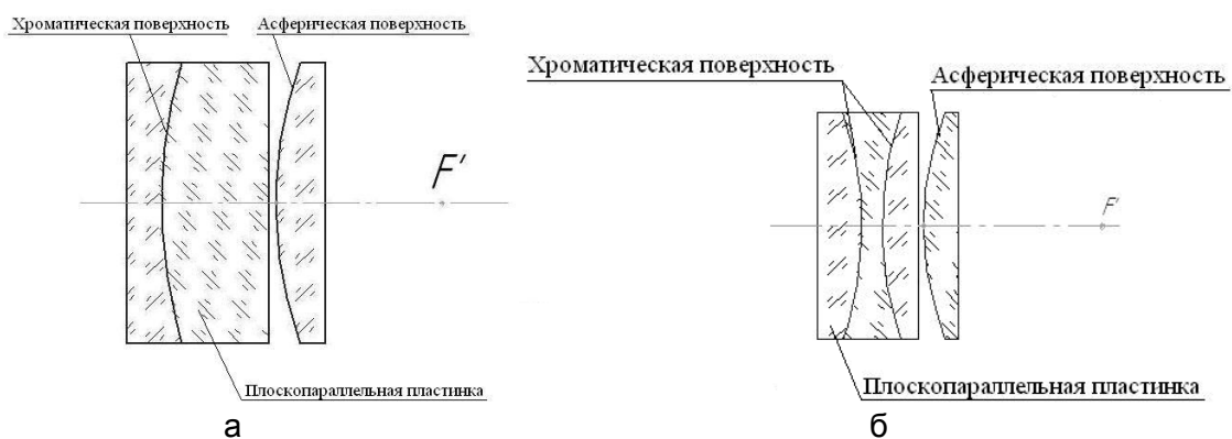
Рис. 2. Оптическая схема двухкомпонентного объектива: плоскопараллельная пластинка с «хроматической» поверхностью, определяющая хроматическую (а) или апохроматическую коррекцию aberrаций (б)
