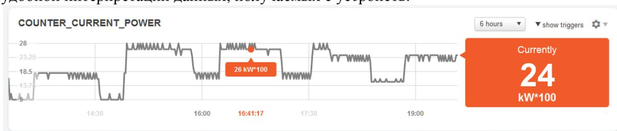
Рис. 1. Пример графика энергопотребления. Данные присланы контроллером, сделанным с использованием собственных разработок и программ. Текущая мощность 240 Вт
