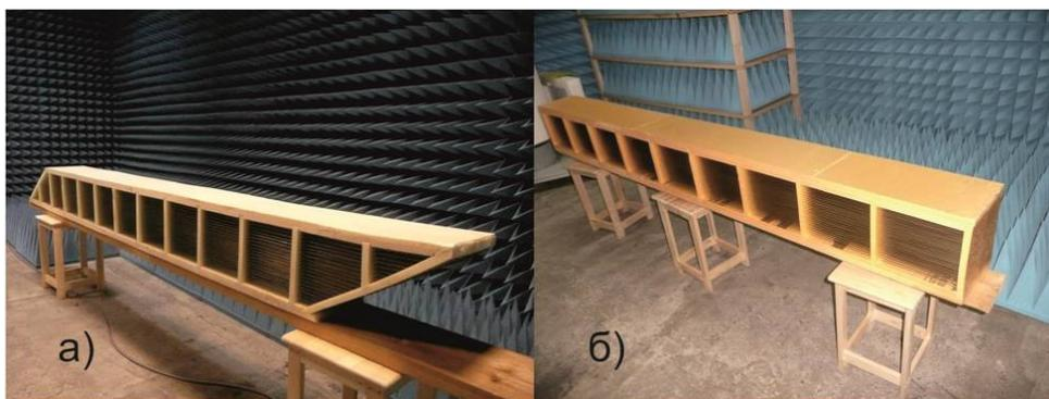
Рис. 1. Фотографии экспериментальных макетов суперлинзы в безэховой камере: суперлинза с наклонными гранями (а); суперлинза с прямыми гранями (б)
