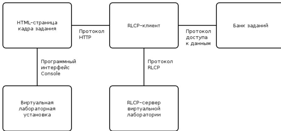
Рис. 1. Структурная схема ВЛ
