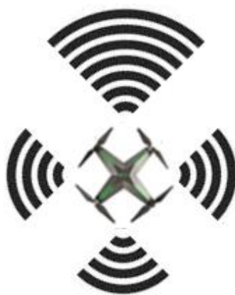
Рис. 7. Расположения дальномеров на квадрокоптере
