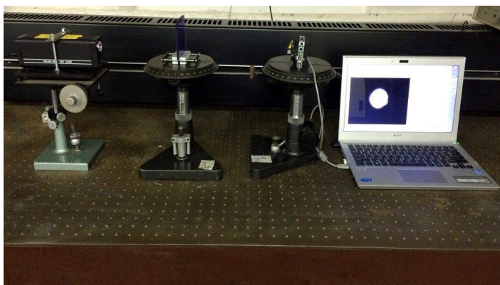
Рис. 3. Стенд для измерения показателя преломления твердых оптических материалов, имеющих форму плоскопараллельных пластин
