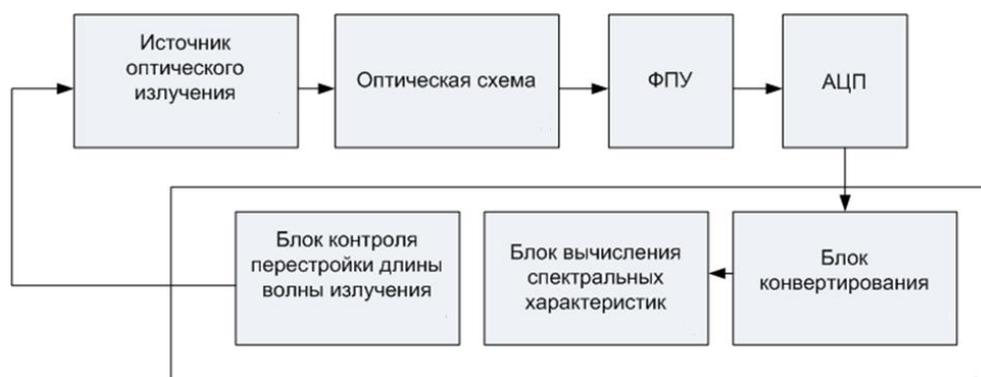
Рис. 3. Схема устройства регистрации спектрального отклика для волоконно-оптических датчиков на основе ВБР
