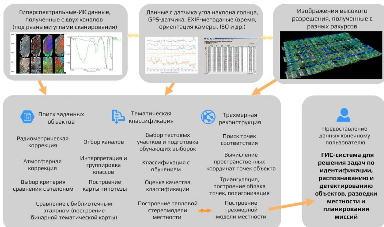
Рис. 4. Структурная схема обработки данных ОЦК дистанционной разведки и картографирования минных полей
