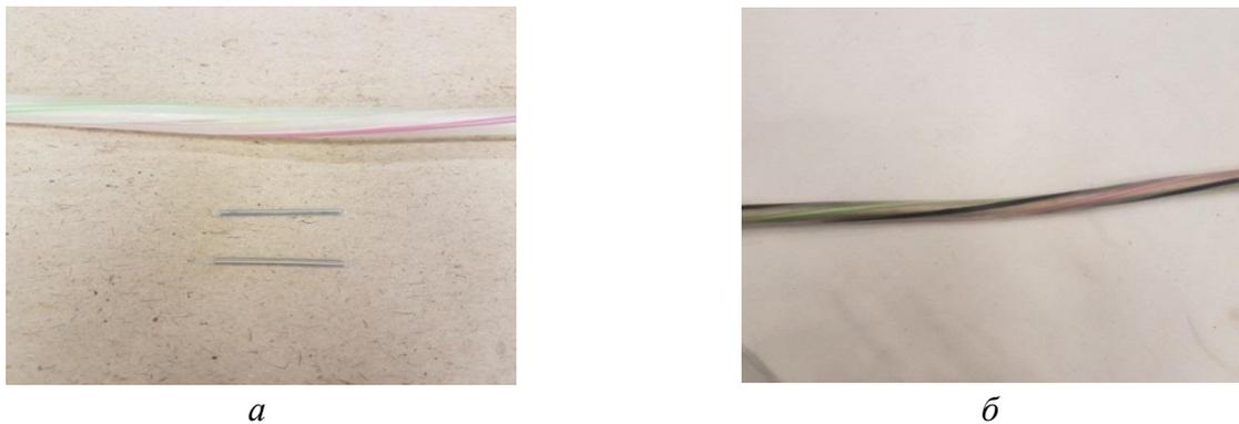
Рис. 3. а – кабельная основа и ВБР в защитной гильзе;
