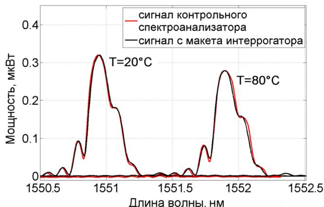
Рис. 5. Экспериментальные данные измерения спектрального отклика ВБР при температурах 20 °С и 80 °С
