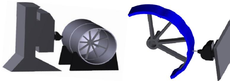
Рис. 1. Схема деформирования обечайки вследствие воздействия сварочного инструмента
