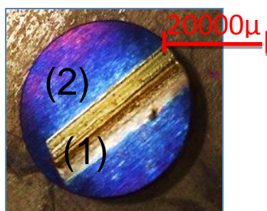
Рис. 3. Оптическая фотография поверхности Ст20: 1 – зона теплового воздействия; 2 – зона воздействия лазерного излучения
