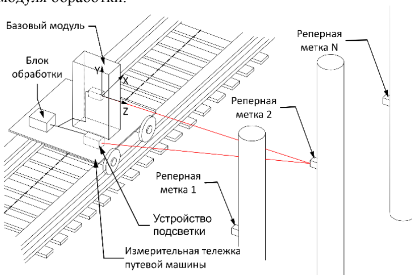
Рис. 2. Принцип работы СТЗ
