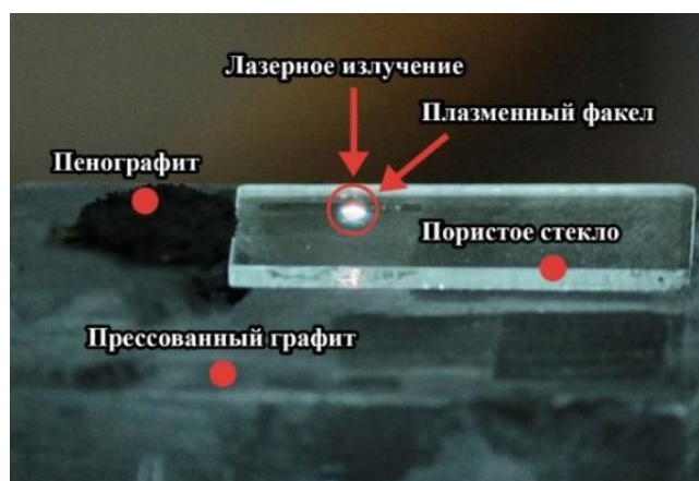
Рис. 2. Процесс микроструктурирования стекла
