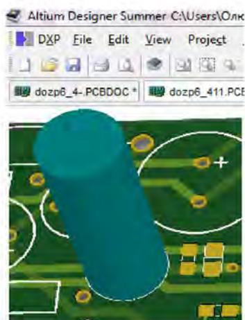
Рис. 3. Трехмерная модель конденсатора
