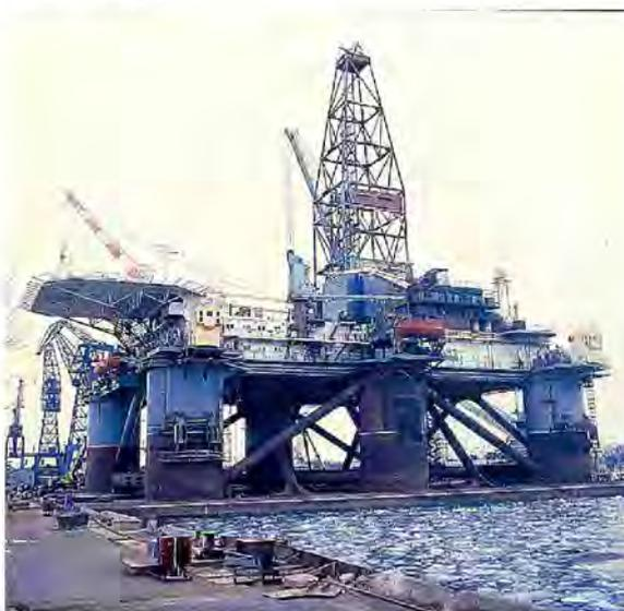
*Рис. 1. Полупогружная буровая установка морского базирования*
