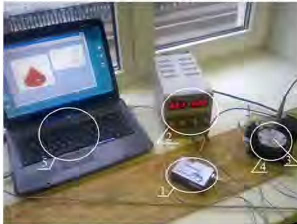
Рис. 11. Экспериментальная установка для исследования индикатрисы реального излучения светодиода: 1 – спектрометр фирмы «Ocean Optics»; 2 – блок питания; 3 – исследуемый светодиод; 4 – моторизованная подвижка фирмы «Standa»; 5 – персональный компьютер
