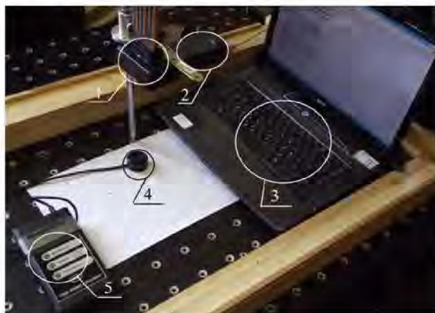
Рис. 13. Экспериментальная установка для определения степени освещения зоны анализа: 1 – макет многокомпонентного источника излучения; 2 – блок управления; 3 – персональный компьютер; 4 – приемник оптического излучения фирма «ТКА»; 5 – люксметр фирма «ТКА»
