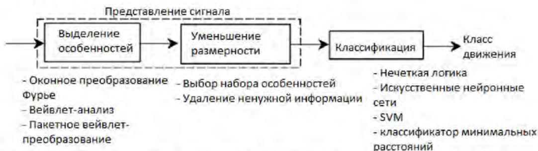
Рис. 8. Схема работы системы с отображением возможных способов классификации и обработки сигнала электромиограмм
