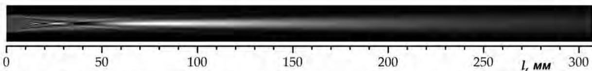
Рис. 2. Продольное распределение интенсивности за круглой диафрагмой, диаметр которой в четыре раза меньше исходной (рис. 1)
