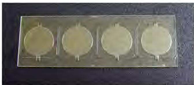
Рис. 2. Фотография чипа, изготовленного из стекла К8 методом кислотного травления и фотолитографии (глубина 200 мкм, диаметр 14 мм)
