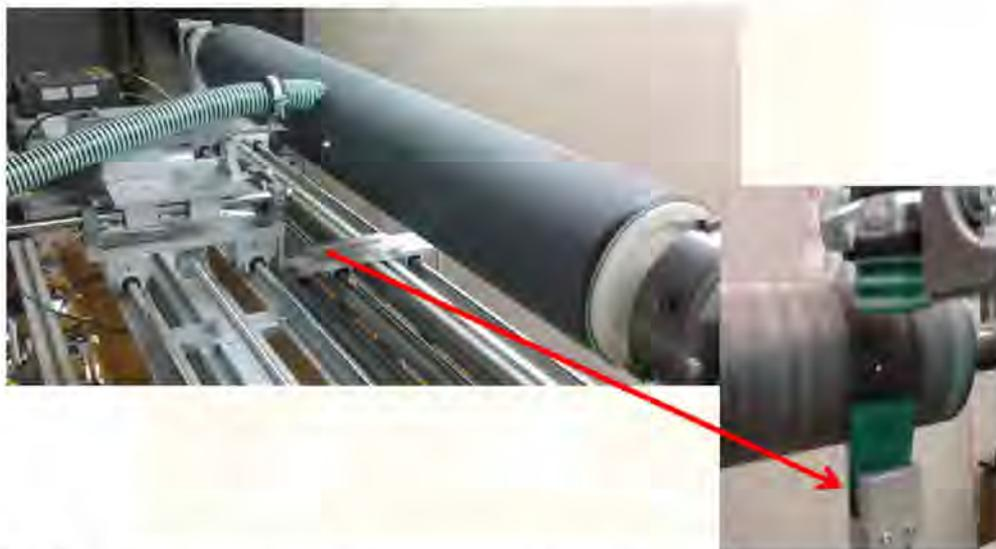
Рис. 9. Экспериментальная установка лазерной очистки анилоксового вала
