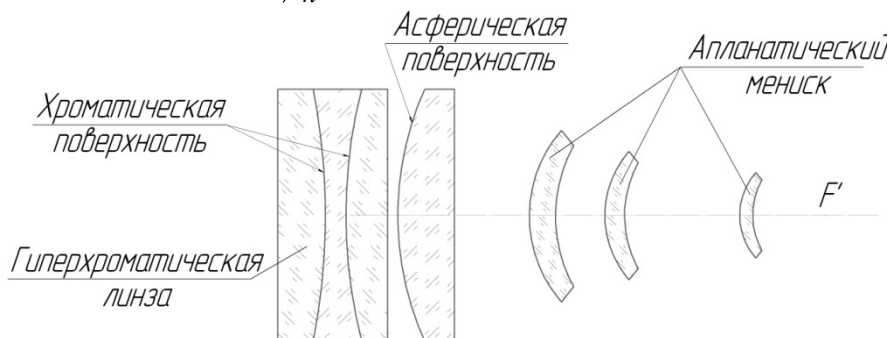
Рис. 4. Оптическая схема светосильного объектива
