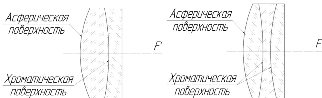
Рис. 1. Оптическая схема однокомпонентного объектива
