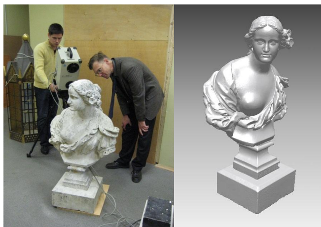
Рис. 6. « Prima Vera »: a – В процессе сканирования, б – полученная электронная копия
