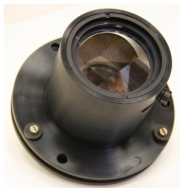
Рис. 10. Тетраэдрический контрольный элемент для трехкоординатных автоколлимационных измерений
