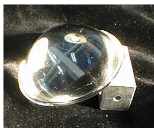
Рис. 10. Лабораторный образец – асферизация стеклянной линзы: а – асферическая линза (оригинал); б – асферическая поверхность, нанесенная на обычную стеклянную линзу (копия)
