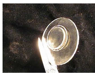
Рис. 10. Лабораторный образец – асферизация стеклянной линзы: а – асферическая линза (оригинал); б – асферическая поверхность, нанесенная на обычную стеклянную линзу (копия)
