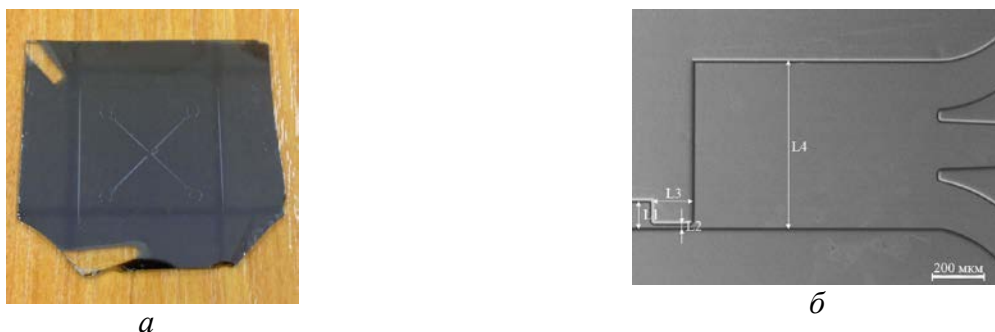
Рис. 3. Изображения: а – шаблон для изготовления МФЧ для гидродинамического разделения частиц в потоке из ПДМС; б – центральная его область (L1–L4 – условные обозначения подконтрольных геометрических размеров)
