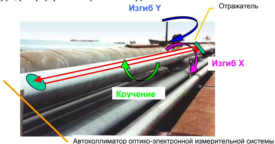
Рис. 1. Трехмерные деформации (изгибы и кручение) трубопровода
