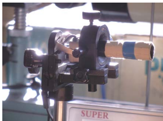
Рис. 9. Матричный регистратор на блоке держателя камеры
