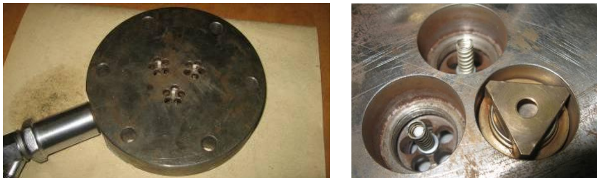
Рис. 3. Фотографии внешнего вида клапанной крышки цилиндра ДКА20-8/1С: а – со стороны цилиндра; б – со стороны впускной камеры
