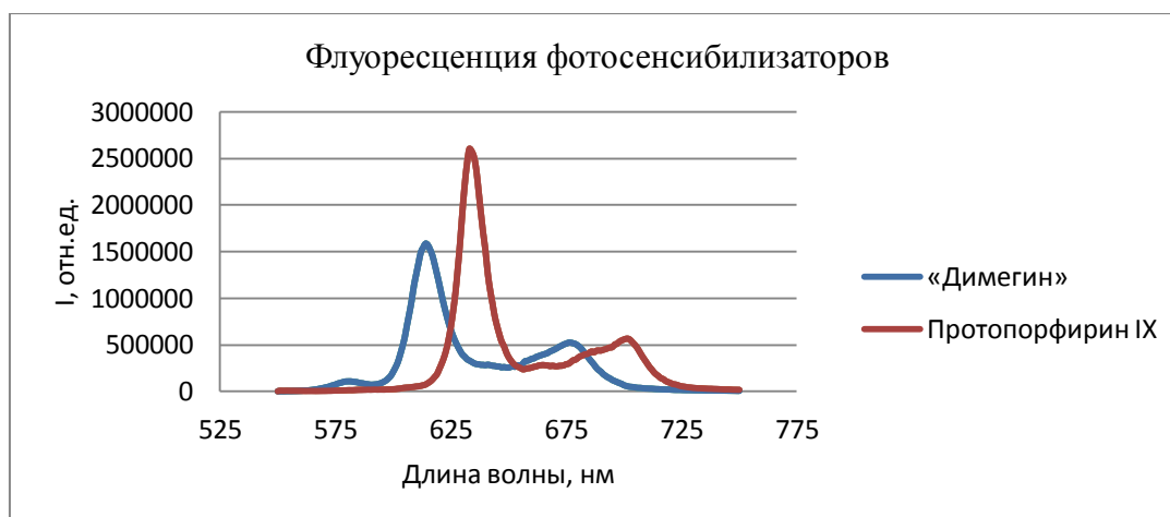
Рис. 3. Спектры флуоресценции «Димегина» и «Протопорфирина IX». Возбуждение флуоресценции производилось на длине волны 404 нм
