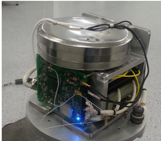
Рис. 2. Внешний вид стенда для исследования электрооптического модулятора в составе ВОГ
