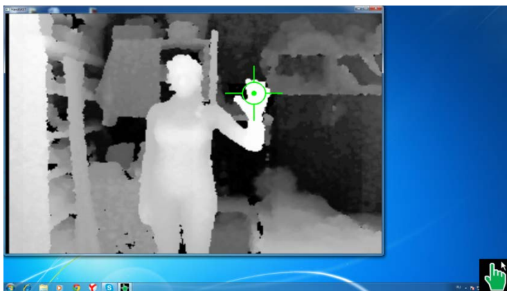
Рис. 2. Фильтрация положения руки. Зеленая область – результат обнаружения руки по одному кадру
