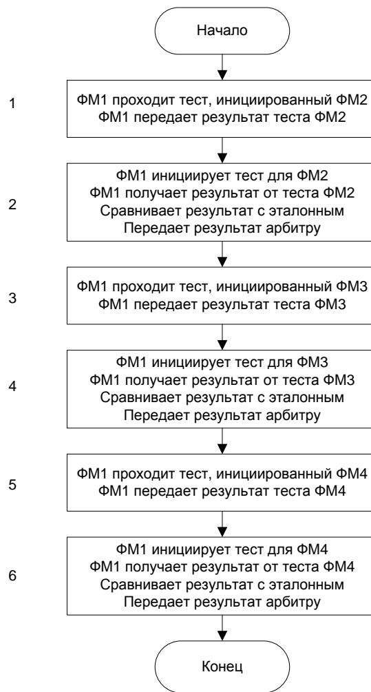
Рис. 2. Алгоритм работы функционального модуля в режиме тестового контроля (пример тестирования для одного ФМ)
