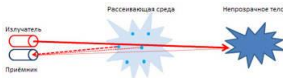
Рис. 1. Принцип действия импульсного дальномера
