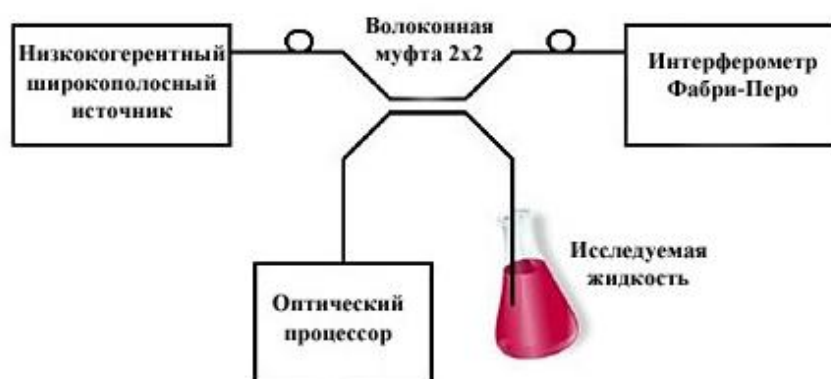
Рис. 2. Базовая установка низкокогерентной интерферометрии
