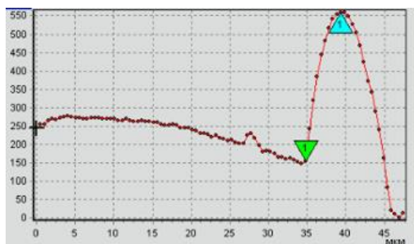
Рис. 6. Результат измерений высоты рельефа, произведенном в программе Nanoeducator
