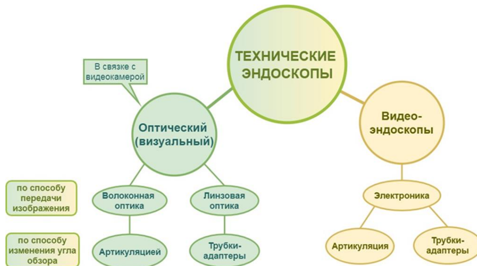
Рис. 1. Классификация технических эндоскопов по способу передачи сигнала и изменения угла обзора
