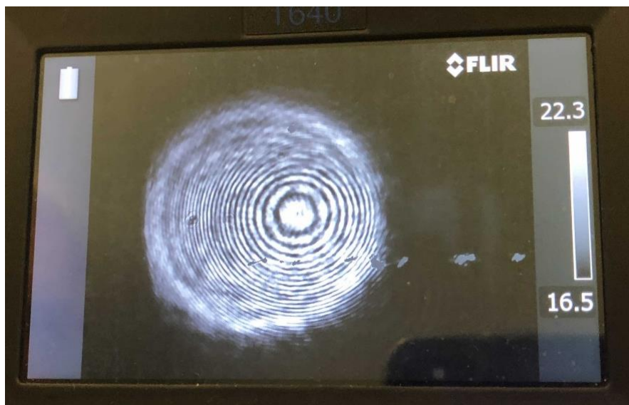
Рисунок. Процесс съятия интерференционной картины телескопической линзы в инфракрасном диапазоне
