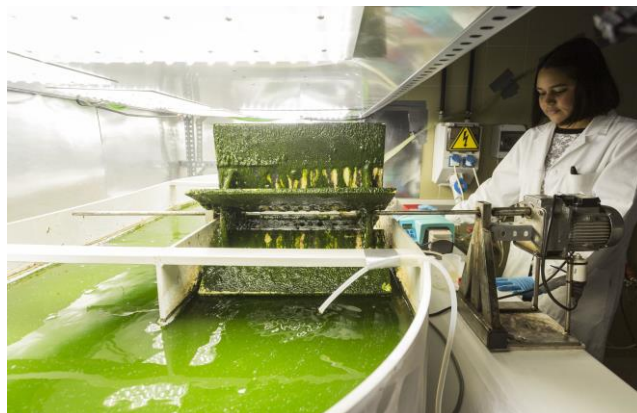
Рис. 4. Экспериментальная установка для выращивания микроводорослей в лабораторных условиях [3]
