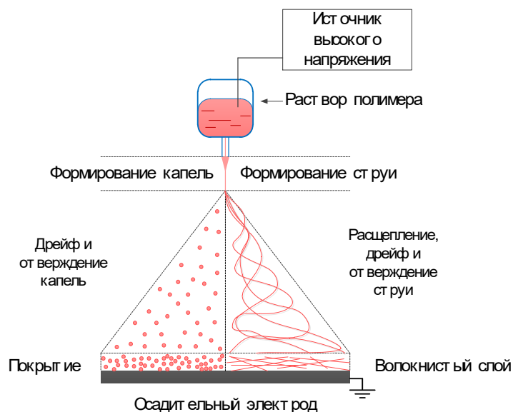
Рис. 1. Принципиальная схема процесса электроформования
