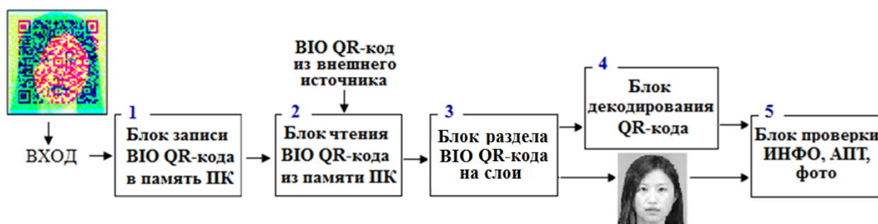
Рис. 3. Функциональная схема контроля записи и расшифровки QR-кодов
