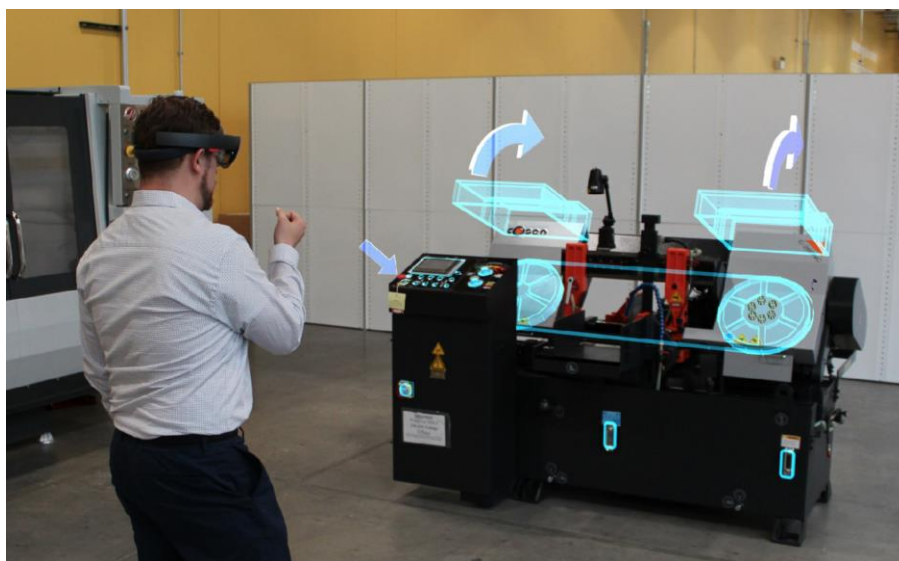
Рис. 2. Использование голографического интерфейса-справки при работе на станке
