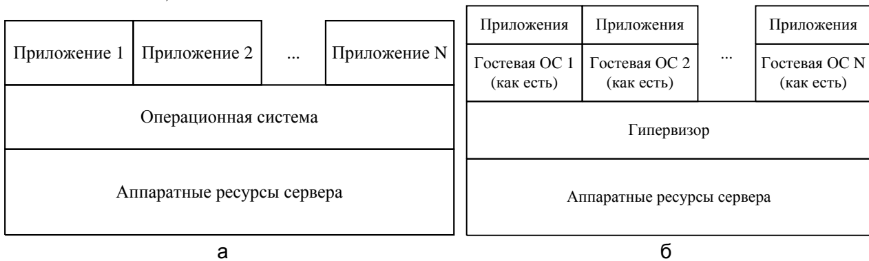
Рис. 1. Схематичное изображение виртуализации приложений (а) и полной виртуализации (б)
