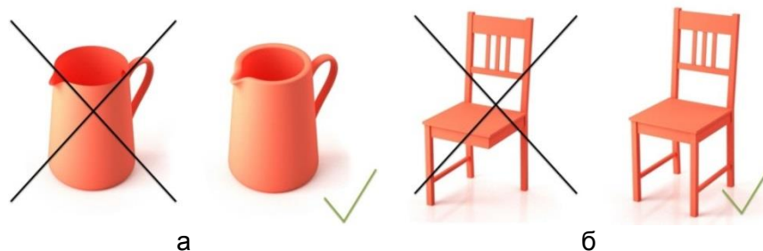
Рис. 1. Минимальная толщина стенок изделия (а); распределение веса (б)
