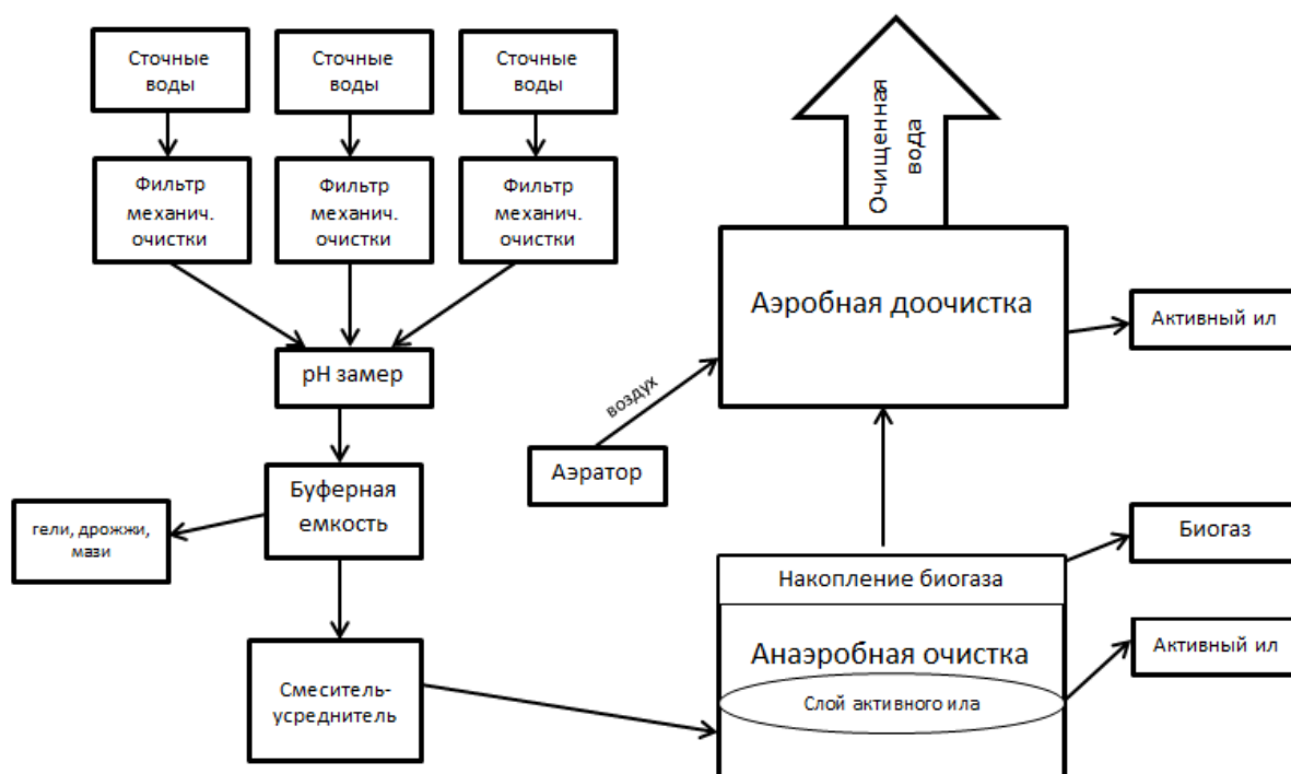
Рисунок. Принципиальная схема очистки комбинированной очистки
