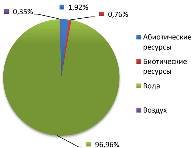
Рис. 2. Структура полного материального потока процесса производства упаковки «Pure-Pak»
