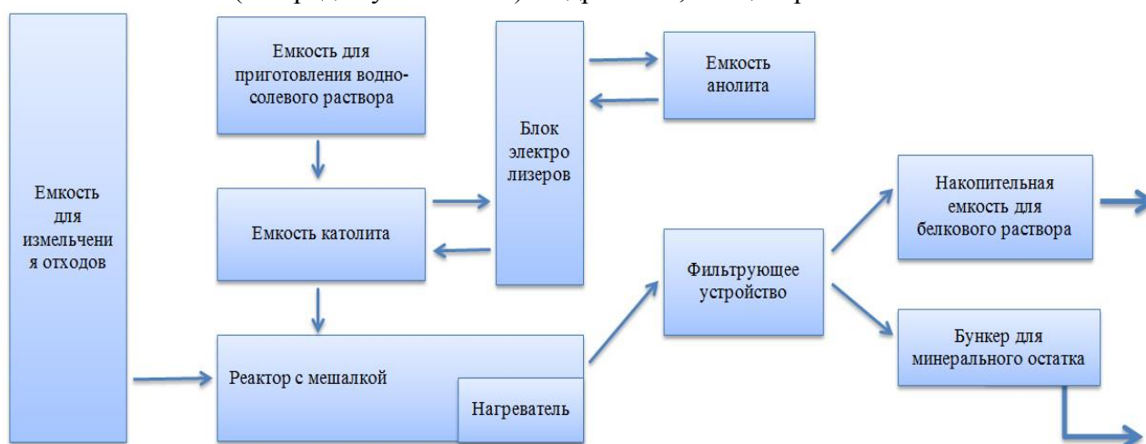
Рис. 2. Принципиальная схема переработки рыбных отходов
