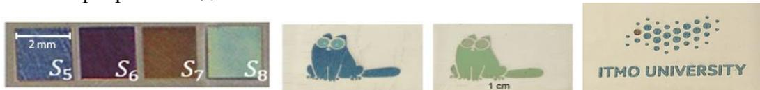
Рис. 3. Цветовая палитра, полученная на поверхности серебра, и примеры нанесенных с помощью данной технологии изображений
