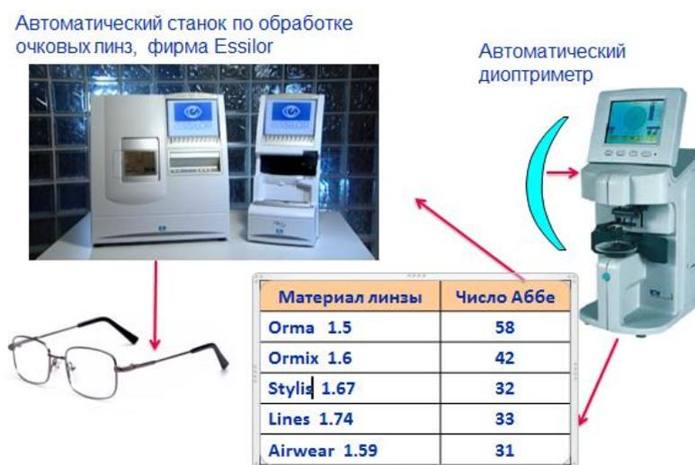
Рис. 2. Алгоритм изготовления очков на современном оборудовании
