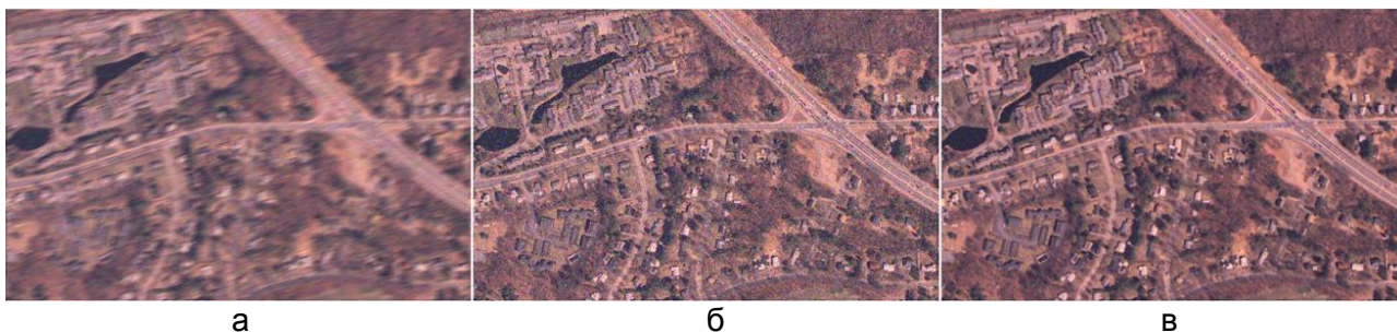
Рис. 4. Изображение, смазанное и зашумленное смазанным импульсным шумом (а); изображение после устранения смаза методом РТ, но с шумом (б); четкое изображение после фильтрации шума медианным фильтром (в)
