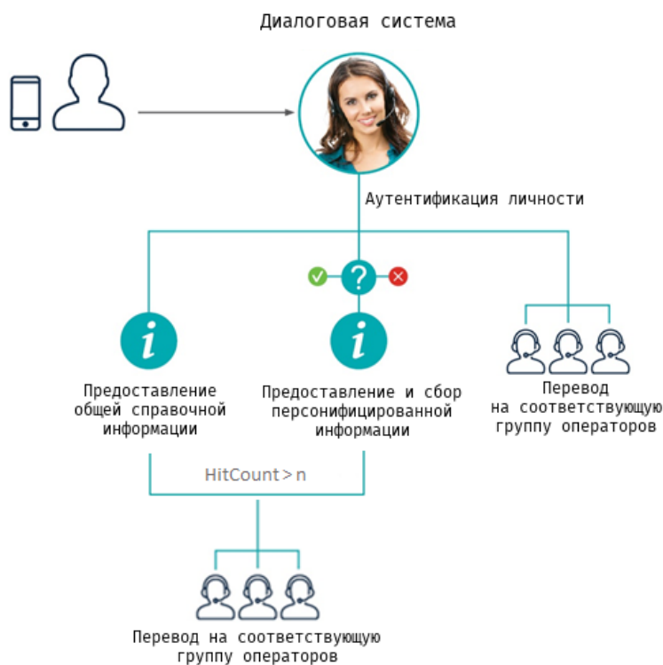
Рис. 2. Схема процесса обработки вопроса пользователя с использованием счетчика попаданий в тему
