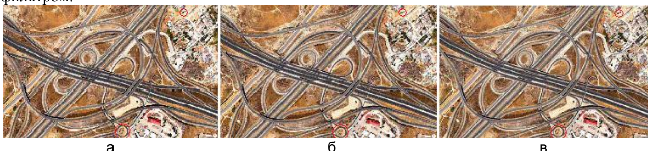
Рис. 4. Результаты устранения биполярного импульсного шума медианным фильтром
