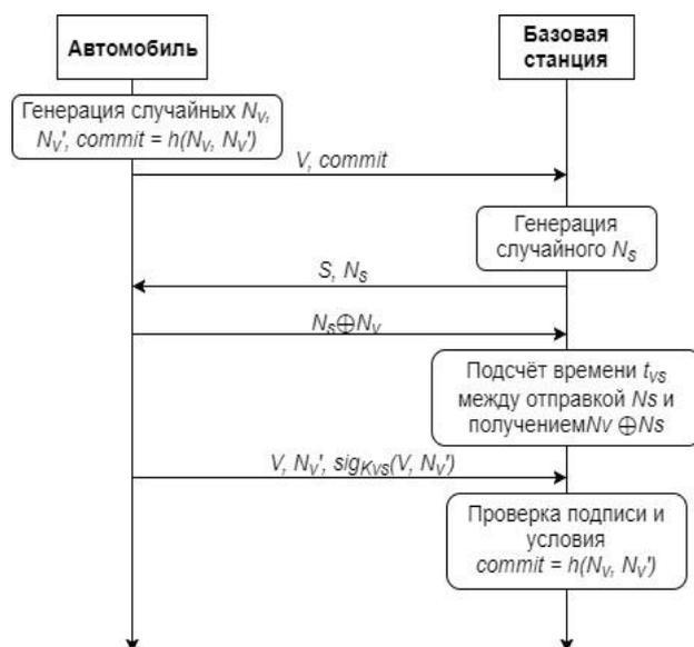
Рис. 1. Протокол передачи информации между базовой станцией и автомобилем
