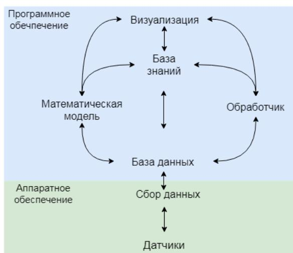
Рис. 1. Структурная схема системы мониторинга
