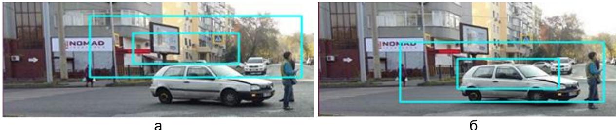
Рис. 3. Результат распознавания автомобиля при использовании только классификатора Хаара с ненормированной обучающей выборкой (а); результат распознавания автомобиля при использовании предложенного алгоритма анализа изображений (б)
