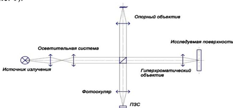
Рис. 1. Упрощенная схема интерференционного микроскопа
