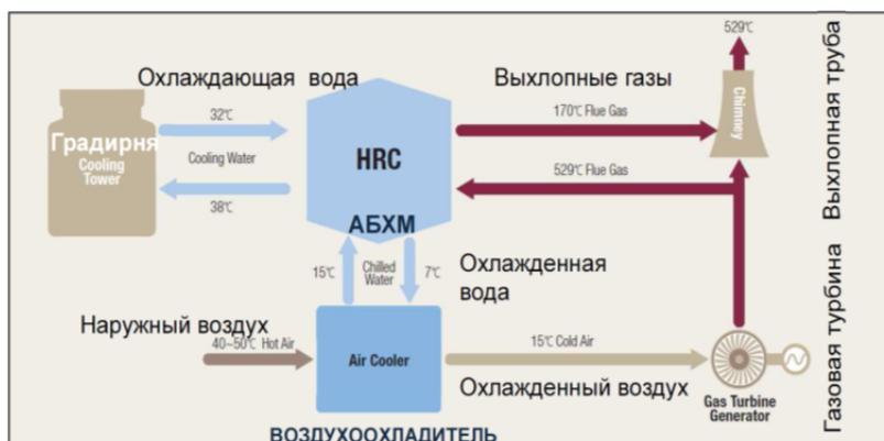
Рис. 4. Система охлаждения воздуха на входе в компрессор ГТУ с применением АБХМ на выхлопных газах
