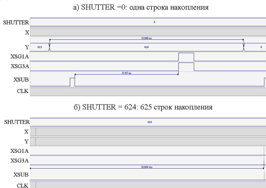
Рисунок. Результаты моделирования управления временем накопления приемника (SHUTTER – входной параметр, задающий число строк накопления): время накопления  $t_n = 17,117$  мкс (а); время накопления  $t_n = 19,984$  мс (б)
