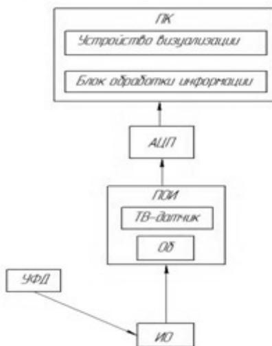
Рис. 2. Структурная схема установки для проведения экспериментальных исследований люминесцентным методом
