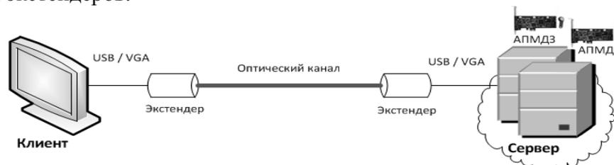
Рис. 2. Схема удаленного подключения периферийного оборудования к терминальным рабочим местам посредством экстендеров
