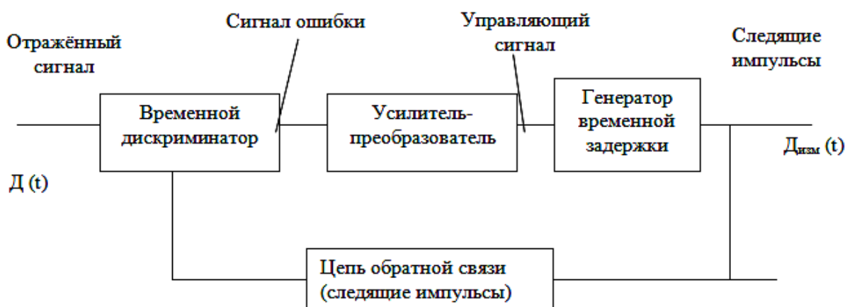
Рис. 1. Обобщенная функциональная схема радиодальномера
