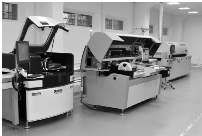
Рис. 5. Высокотехнологическая линия поверхностного монтажа
