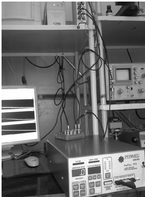
Рис. 1. Лабораторная установка для замера кровотока под слизистой желудка методом доплеровской флоуметрии
