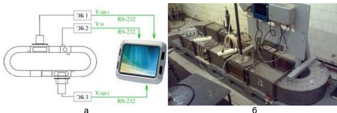
Рисунок. Структурная схема (а) и опытный образец (б) унифицированного стенда испытаний индукционных лагов
